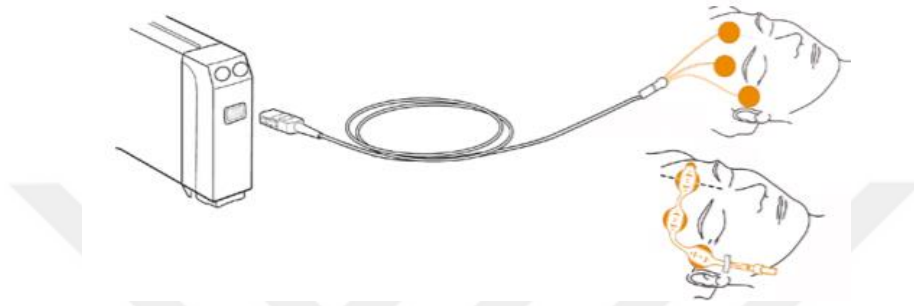
Şekil 2. Entropi elektrotlarının yerleşimi.
