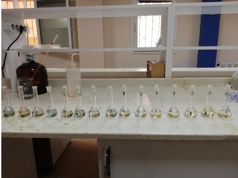
Şekil 3.4. Fosfor analizi (olsen metodu)
