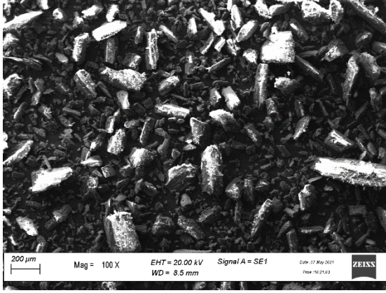
Mannitole ait 200 μm ve 30 μm SEM görüntüleri
