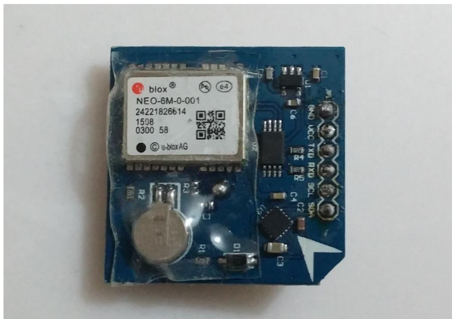
Şekil 4.10. u-blox NEO-6M GPS modülü
