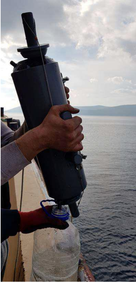
Ek 2. Resim 2. Su Örneklemelerinde Kullanılan 5 L'lik Nansen Şişesi
