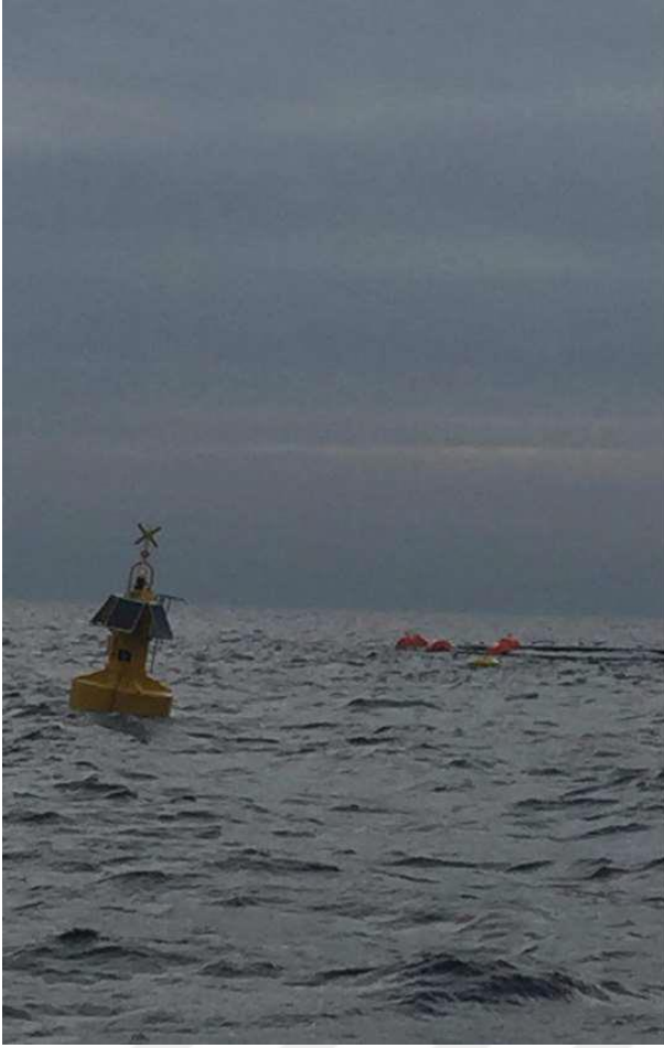
Ek 2. Resim 10. Başaran Orkinos Ağ Kafes Tesisinin bulunduğu bölgede kurulan Online Su Parametreleri ve Akıntı İzleme İstasyonu (Ekolojik Şamandıra, Eco- Buoy) (Yenilenen sistem)
