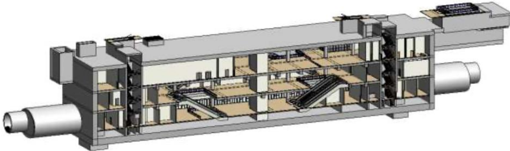
Şekil 17: Aç-Kapa Tipi İstasyonun YBM Programlarında Görünümü
