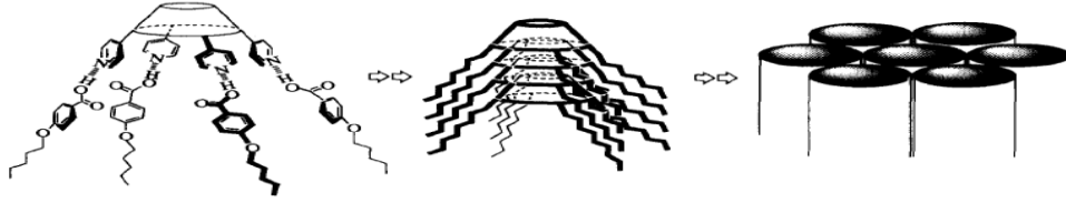
Őekil 1.27 Őematik istifleme kaliks [4] aren ve mezofaz oluřum gsterimi (Mn: n \sim 12 ).
