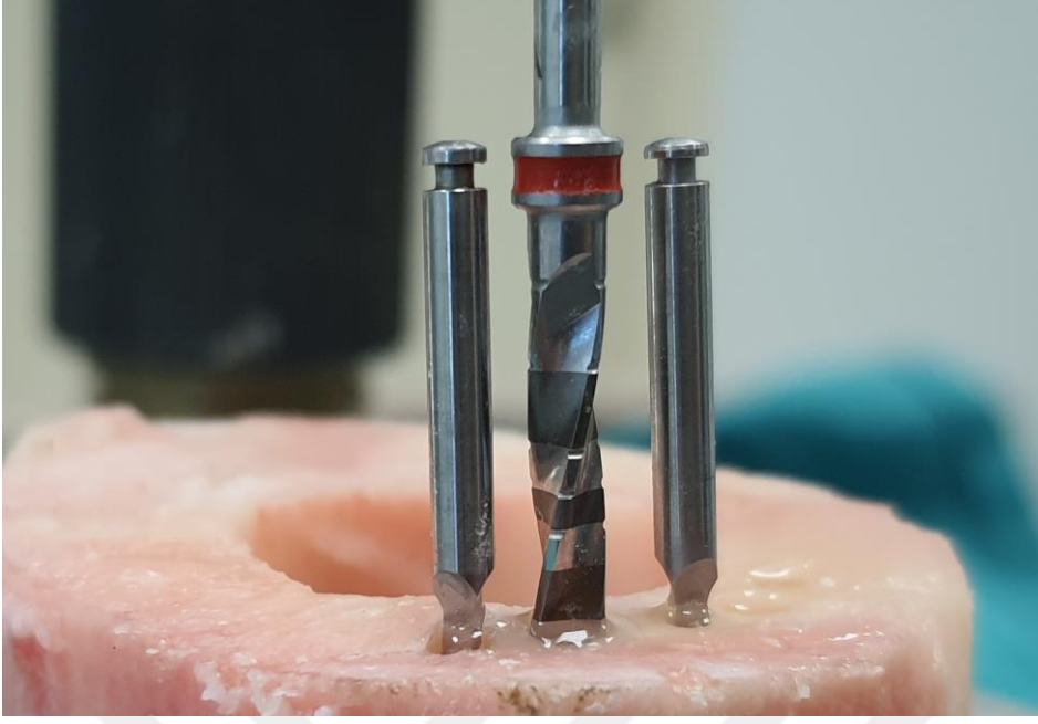
Resim 3. 5. Dril ile ısı sensör yuvalarının anguldruva başlığın ısı sensörlerine teması nedeniyle tam olarak gösterilemeyen paraleliğini göstermek amacıyla ısı sensör yuvalarına frezler yerleştirilerek gösterilmesi
