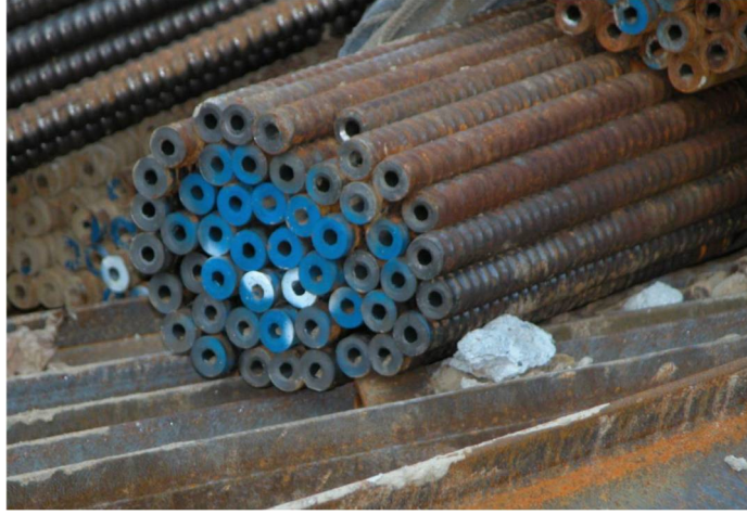
Şekil 3.27. Kaya bulonlama çalışmalarında tercih edilen içlerinde delik bulunan nervürlü demir çubuklar (Nurnur, 2016).
