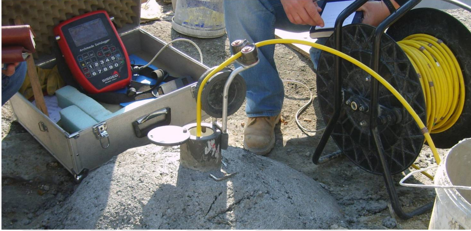
Şekil 3.52. İnklinometre cihazının kurulum çalışması (Çeçen, 2007).
