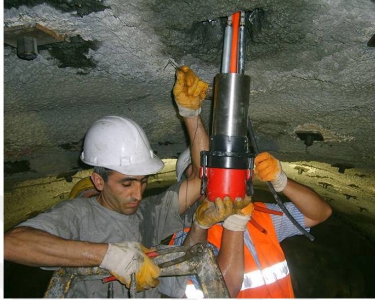
Şekil 3.53. Tünel içerisinde kurulumu yapılan Ekstansometre cihazı (Yüceses, 2019).
