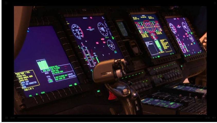
Resim 5. 5. T-70 ASELSAN IMAS Aviyonik Entegreli Kokpit Görüntüsü
