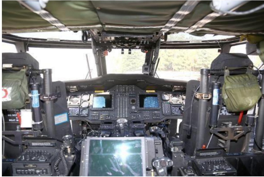
Resim 5. 4. Mevcut Sikorsky (S-70) Helikopterinin Kokpit ve Aviyonik Cihazları
