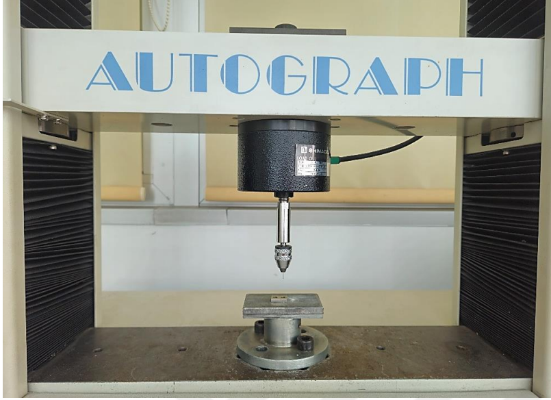
Resim 3.12. Push-out testinin uygulandığı evrensel test cihazı
