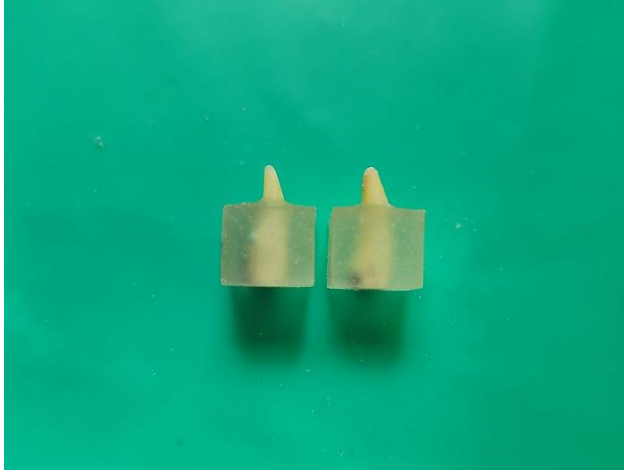
Resim 3.8. Apikal 3 mm'lik kısmı dışarıda bırakılarak akrilik rezin içerisine gömülen örnekler
