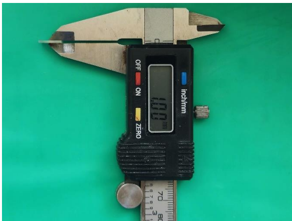
Resim 3.10. Kesit kalınlıklarının dijital kumpas kullanılarak ölçülmesi
