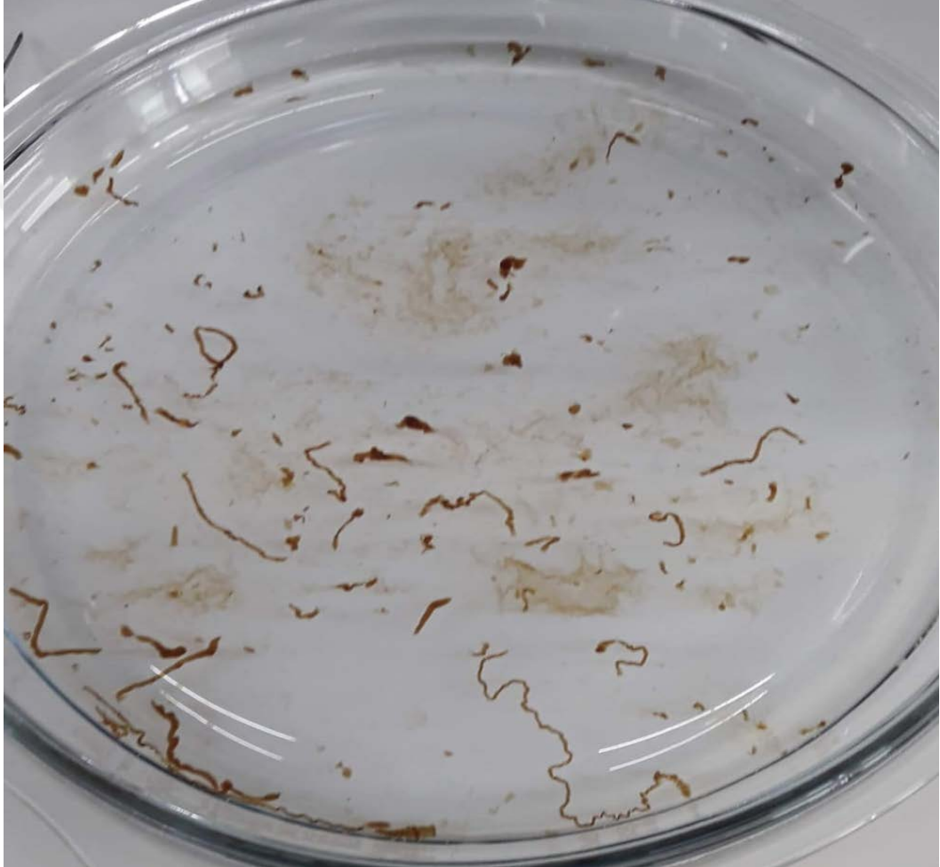
Şekil 4.5 : 250 µm iç çaplı iğne ucu denemesi
