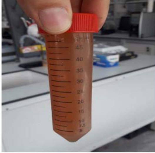
Şekil 4.2: Üretilen grafen oksit çözeltisi ve kuruyan film
