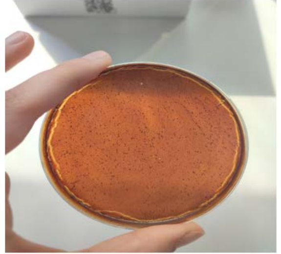
Şekil 4.2: Üretilen grafen oksit çözeltisi ve kuruyan film
