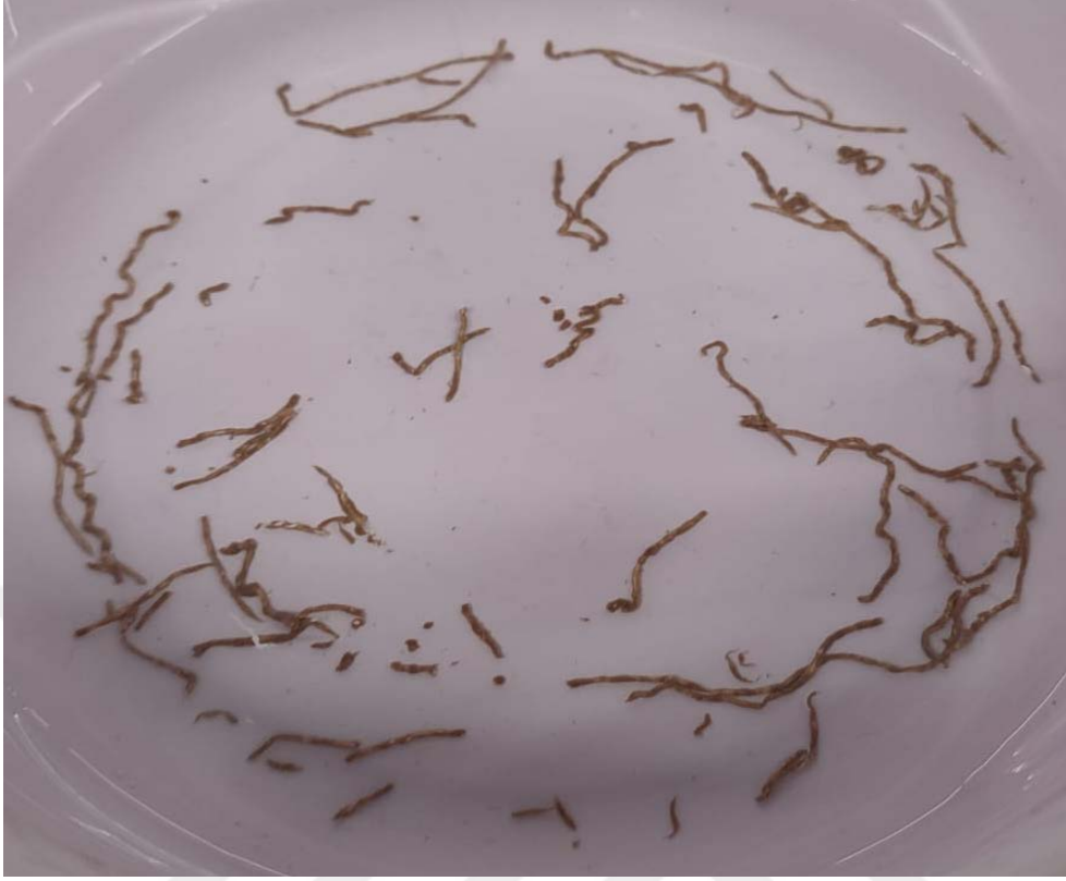
Şekil 4.6 : 360 µm iç çaplı iğne ucu denemesi
