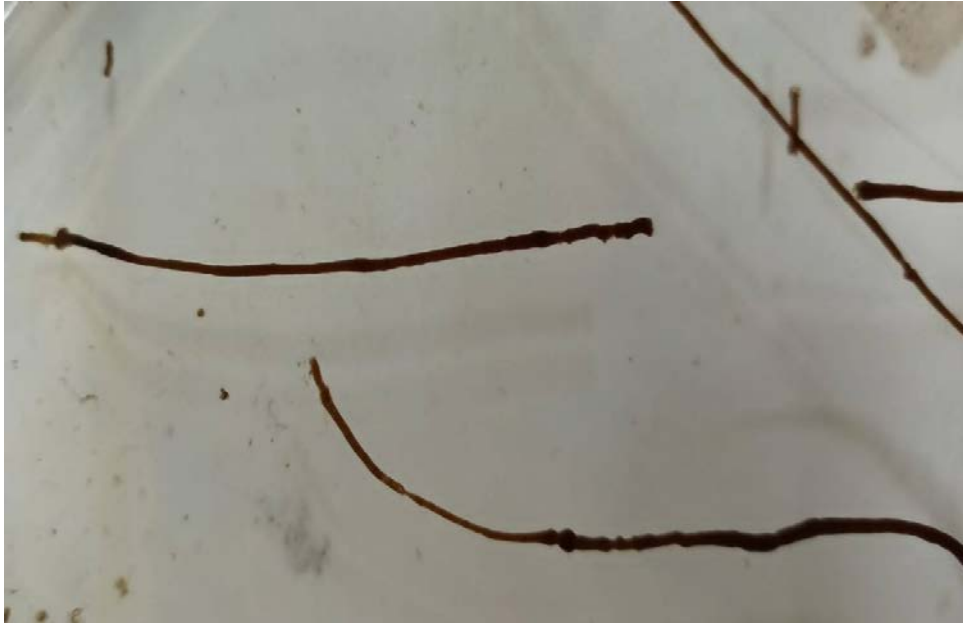
Şekil 4.7 : 440 µm iç çaplı iğne ucu denemesi
