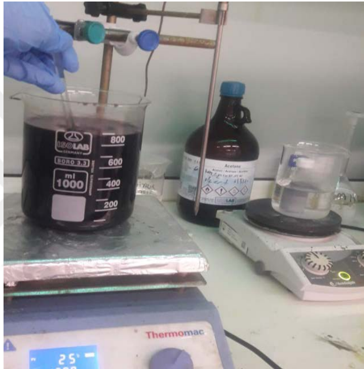
Şekil 4.1 : Geliştirilmiş Hummers metoduyla sentezlenen grafen oksit çözeltisinin 12 saat sonraki hali
