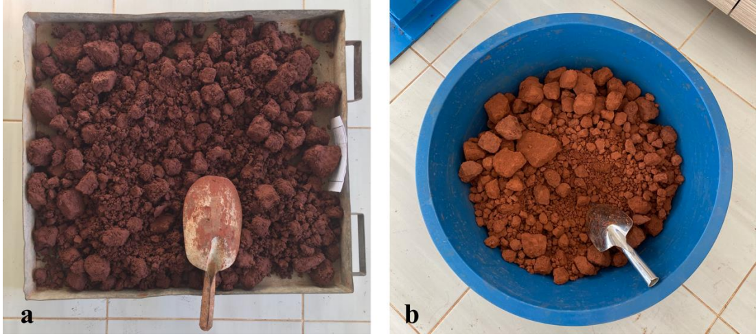
Şekil 3.2. (a) Doğal ve (b) oda sıcaklığında kurutulmuş kırmızı çamur numunesi
