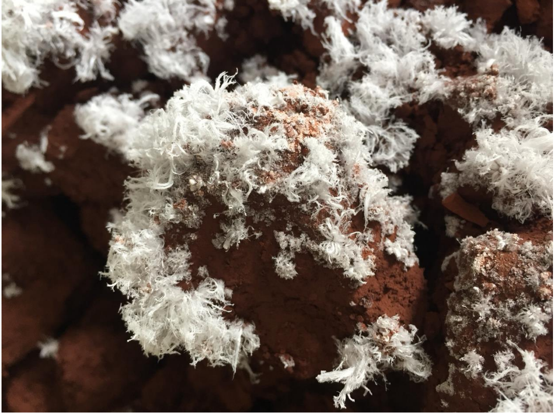
řekil 4.5. Kırmızı amurda havada kuruma sonucu kristal oluřumu
