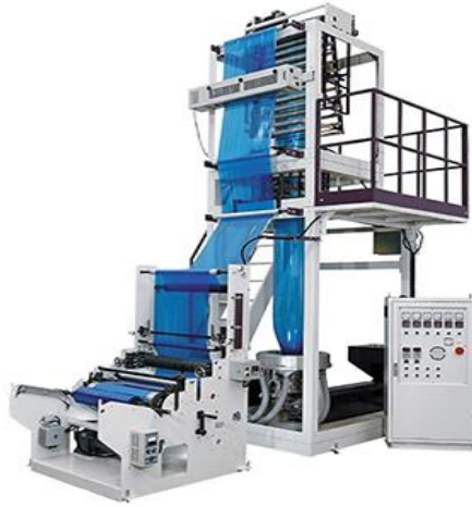
Şekil 2.14. Şişirme film ekstrüzyon makinesi (Matila, 2024).
