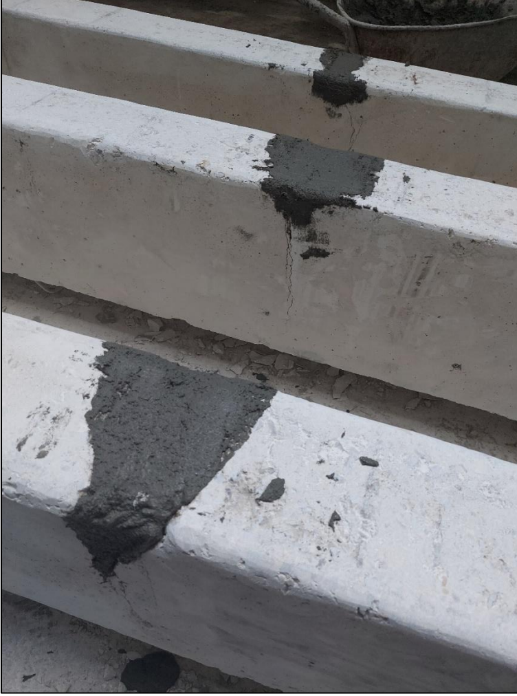
Resim 3.11. Tamir harcı uygulanmış deney numuneleri
