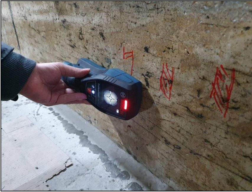
Resim 3.4. Donatı tespit cihazı
