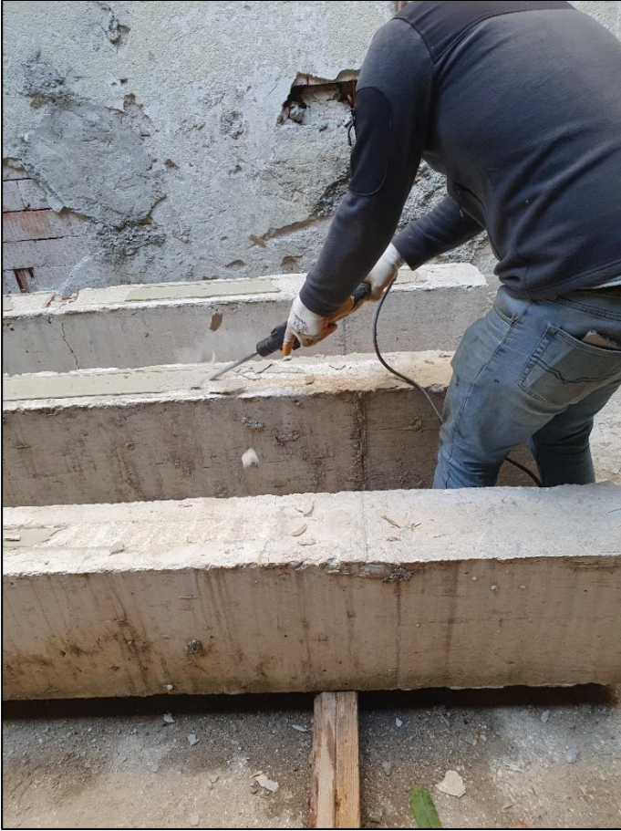
Resim 3.5. İlk deneyden kalan plaka yapıştırıcısı kalıntılarının temizlenmesi
