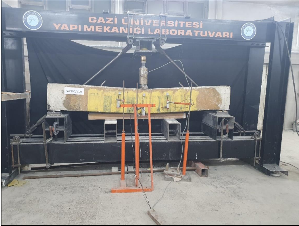
Resim 4.18. SW100-1,00 deney sonrası fotoğrafı
