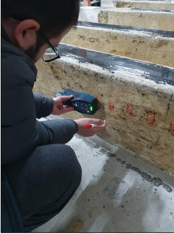
Resim 3.19. Kiriş donatı yerlerinin belirlenerek işaretlenmesi
