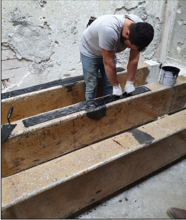
Resim 3.17. El ile basınç uygulanarak boşluğu alınan deney elemanları
