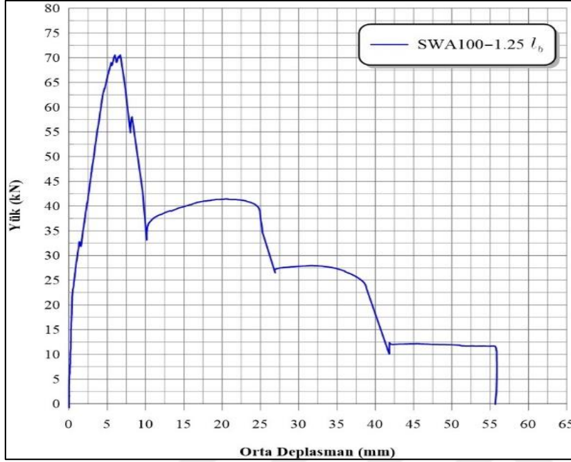
Şekil 4.15. SWA100-1,25 deney elemanı yük-deplasman ilişkisi
