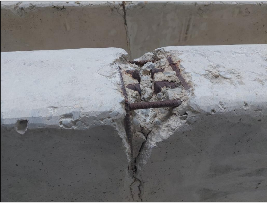
Resim 3.7. Beton parçalarından arındırılmış numune
