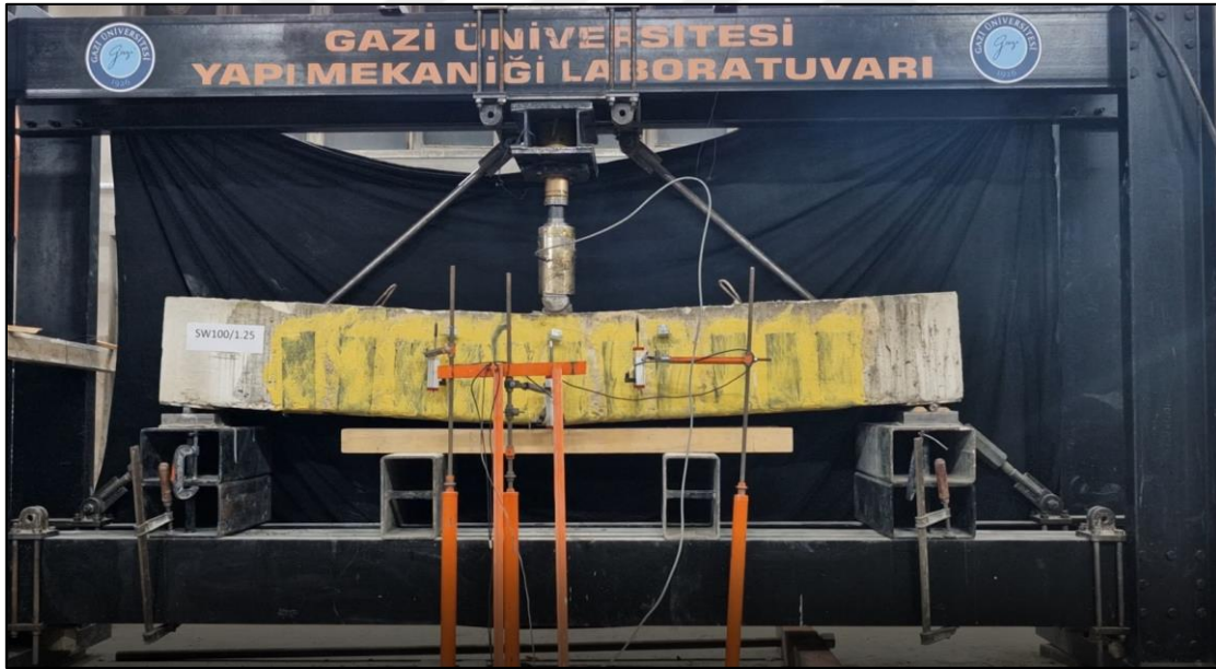
Resim 4.21. SW100-1,25 deney sonrası fotoğrafı
