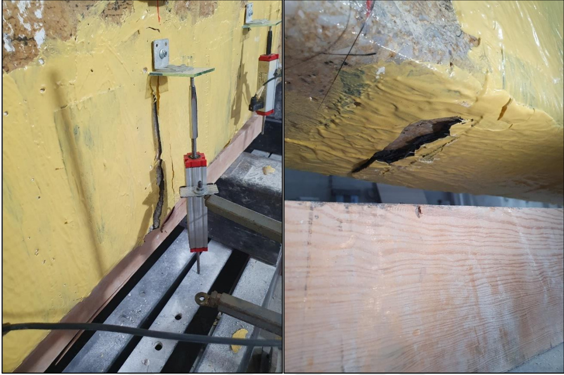
Resim 4.16. SW100-0,75 deney sonrası fotoğrafı
