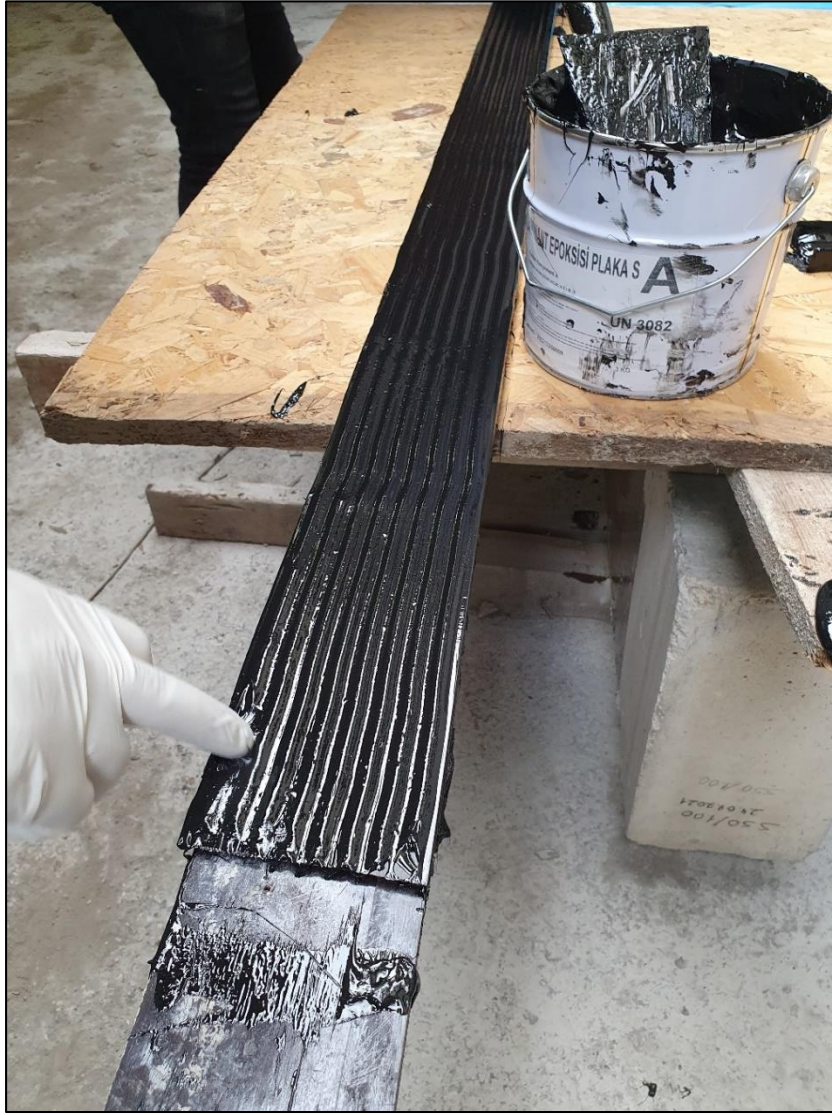
Resim 3.16. Macun serimi gerçekleştirilerek taraklanan plaka yüzeyi
