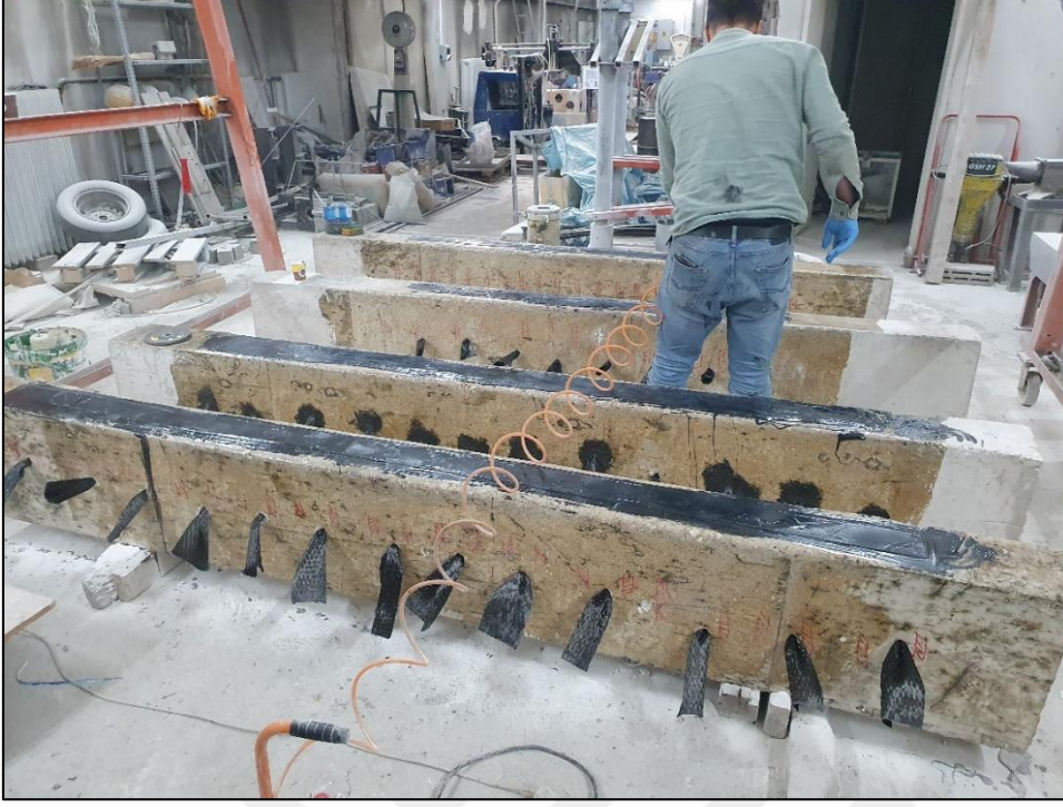
Resim 3.32. Karbon kumaşların ankraj deliklerindeki yerleşimi
