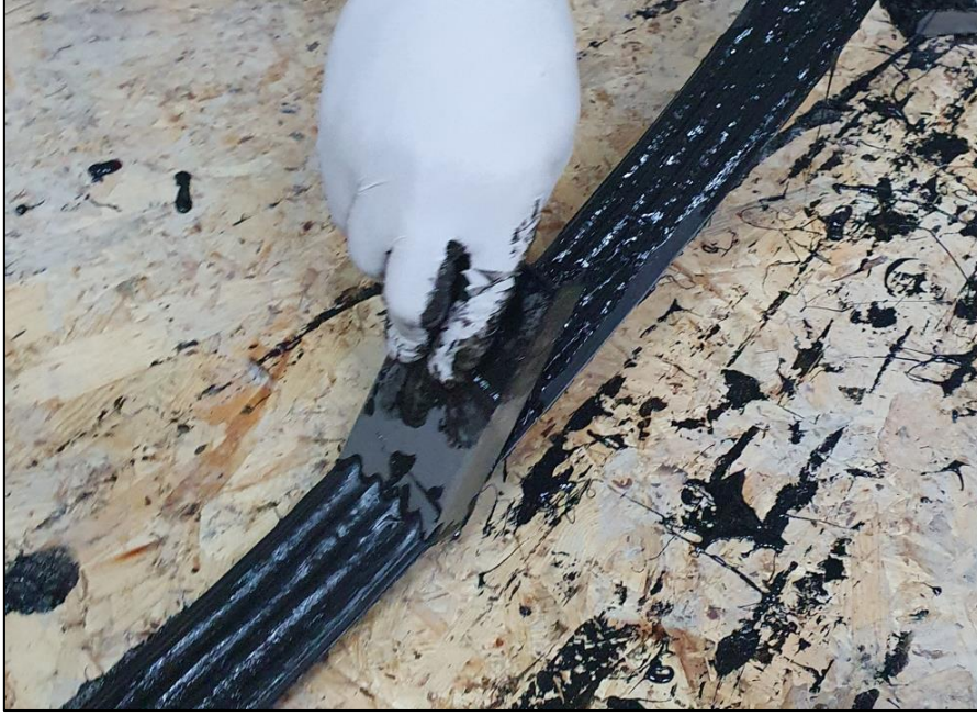
Resim 3.1. Epoksi macunu kalınlığı ayarlama aparatı
