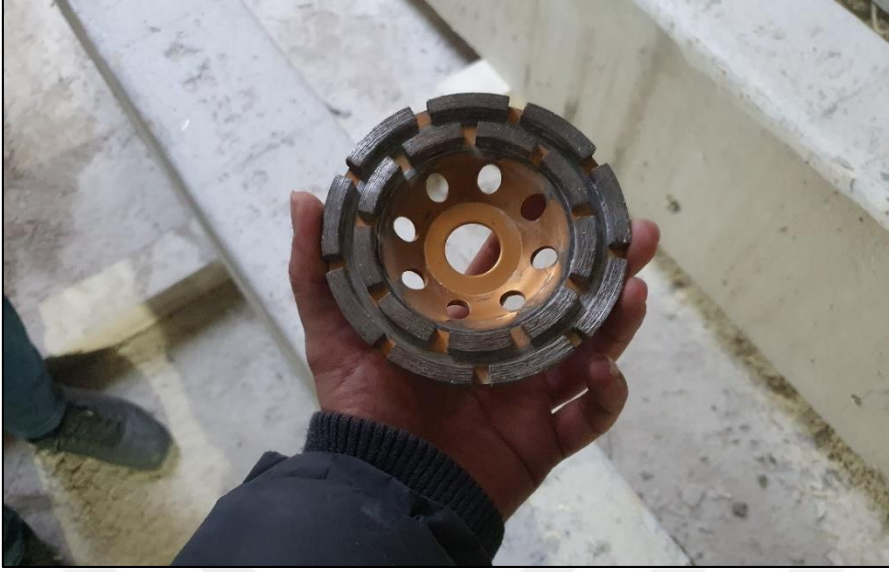
Resim 3.3. ift sıra elmaslı beton yüzeyi silme aparatı
