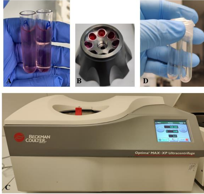
Resim 5. Eksozom izolasyon çalışmaları A) Eksozom içeren hücre besiyerinin ultrasantrifüj tüplerine doldurulması B) Ultrasantrifüj rotoru C) Eksozom izolasyonu için kullanılan ultrasantrifüj cihazı D) Ultrasantrifüj sonrası çöken eksozom pelleti.
