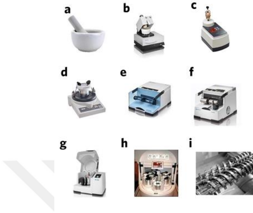
Şekil1.22. Yaygın olarak kullanılan öğütme ekipmanı. (a) Havan ve tokmak, (b) otomatik havan, (c) dikey titreşimli mini değirmen, (d) titreşimli mikro değirmen, (e) titreşimli bilyalı değirmen, (f) sıcaklık kontrollü titreşimli bilyalı değirmen, (g) gezegen bilyeli değirmen, (h) çoklu numune alma değirmeni ve (i) sürekli mekanokimyasal sentez için çift vidalı değirmen (Wang ve ark., 2023a).
