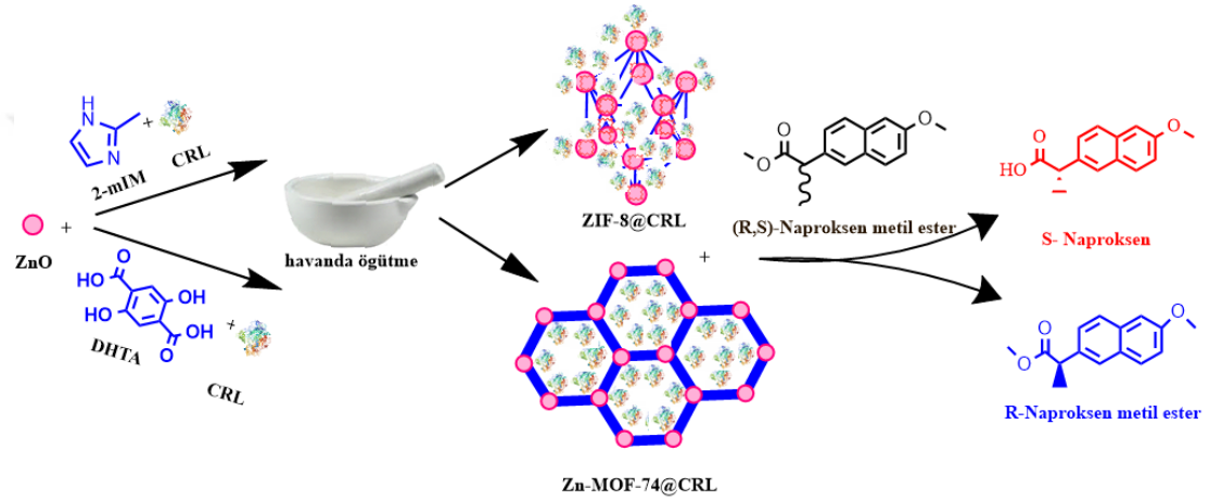
Şekil 1.33. Mekanokimyasal yöntem ve iki çinko bazlı metal organik kafes (ZIF-8 ve Zn-MOF-74) kullanılarak, immobilize enzimlerin Rasemik Naproksen metil esterinin enantiyoselektif hidroliz reaksiyonunda kullanımı (Ozyilmaz ve Caglar, 2023).
