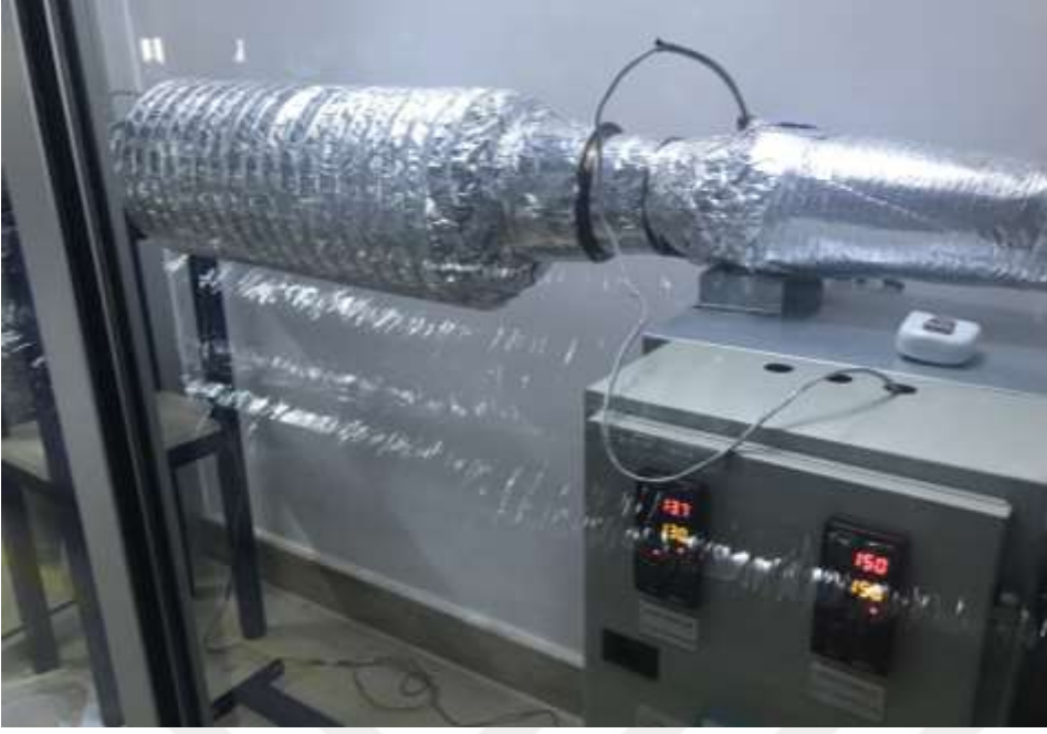
Resim 4.2. Sıcaklık dayanım cihazında test ölçümü
