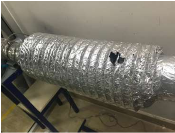
Resim 4.8. Sıcaklık dayanımında 25 mm izoleli kauçuk köpük ve 25 mm hava boşluğu takılı iken
