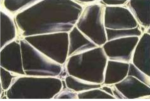
Resim 2.5. Elastomerik kauçuk köpüğünün mikro yapısı (Taşçı, 2004)
