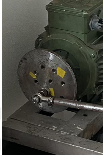
Resim 3.7. Laboratuvar tipi sarsıcı düzen eksantrik mekanizması
