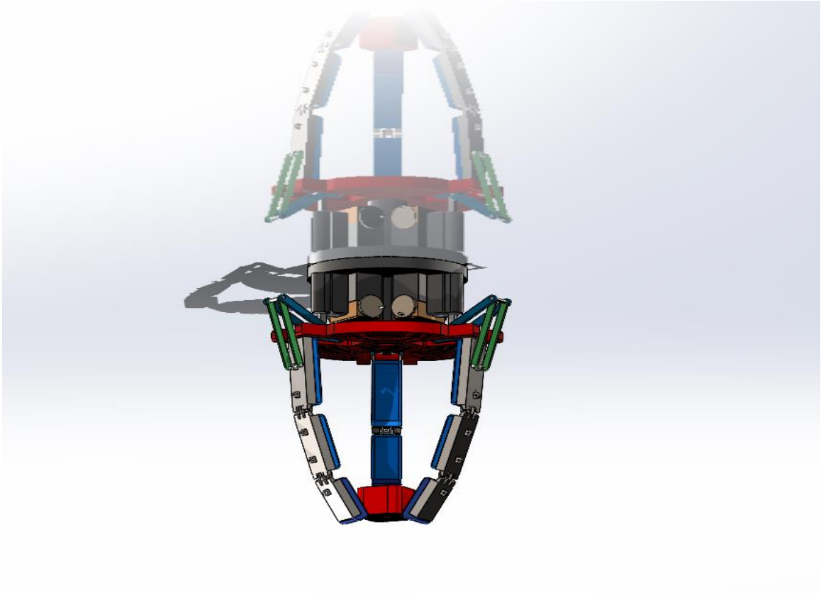
Şekil 3.8. Solidworks ortamında tutucu montajı.
