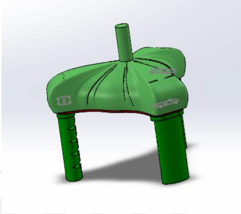
Şekil 3.1. Esnek tutucu SolidWorks ilk tasarım.
