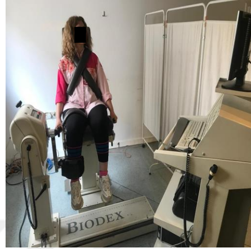
Şekil 3.3. İzokinetik dinamometre ile kas kuvveti ölçümü.
