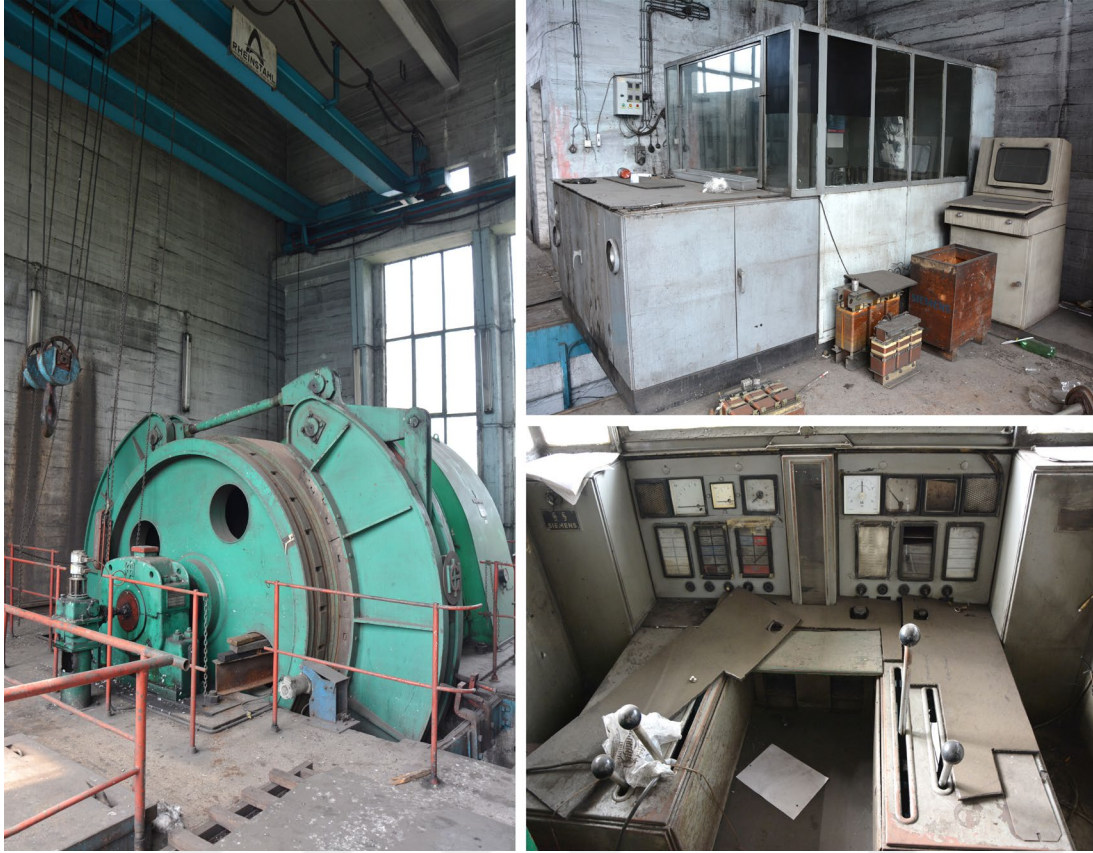
Şekil 5. 22: Gutehoffnungshütte kuyu vinci (1965) ve Siemens kuyu vinci operatör paneli. Merve Varol Can, 2023.
