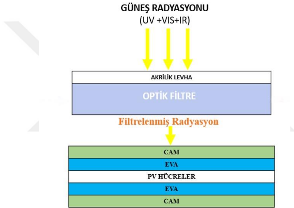
Şekil 1.7: Optik filtre ve PV/T sistemin şematik görünümü
