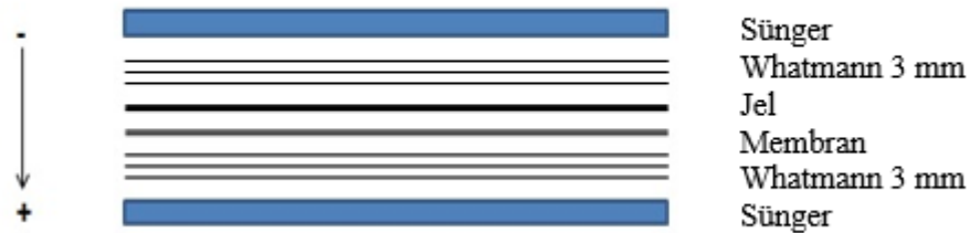
Şekil 3.3. Blot transfer aparatına jel ve membranın yerleşimi
