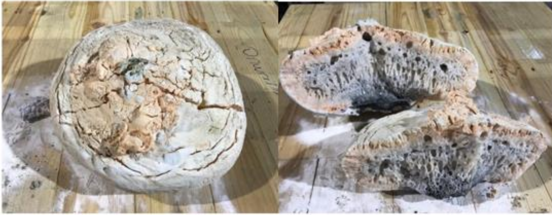
Şekil 6.20 : Elektroliz kalite alüminadan elde edilen ergimiş alümina üstten ve yandan görselleri (Deney 3).
