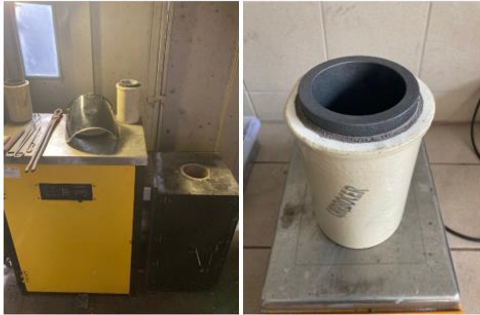
Şekil 6.12 : İndüksiyon fırını ve içerisinde ergitmenin yapıldığı F9 potası.
