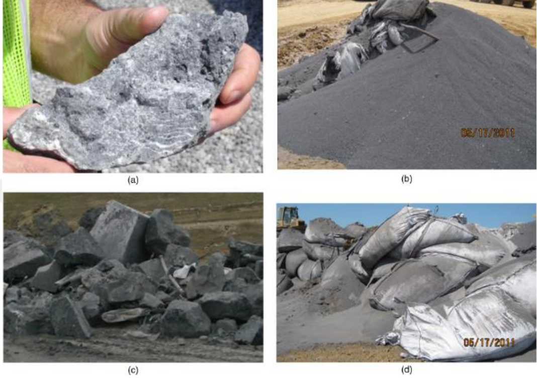
Şekil 4.5 : Alüminyum üretiminden kaynaklanan atık ürünler şunları içerir: (a) beyaz dros; (b) siyah dros; (c) tuz keki; ve (d) torba tozu [28].
