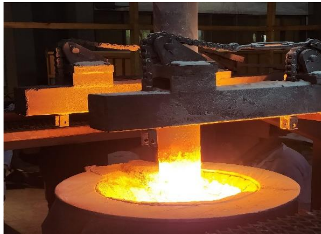
Şekil 6.22 : Elektroliz kalite alüminanın elektrik ark fırınında ergitme işlemi.
