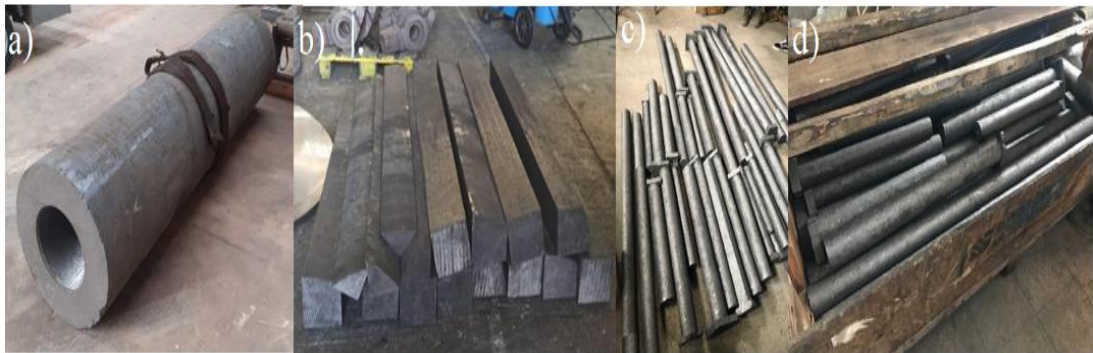
Şekil 6.18 : UHP Grafit (a) alındığı haliyle elektrot, (b) kesme ve dilimleme işlemlerinden sonra, (c) tornalama işlemlerinden sonra ve (d) son işlemden sonra.
