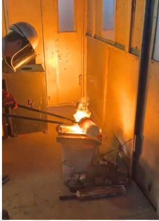
Şekil 6.13 : Deney sonucunda elde edilen ergiyik fazın dökümü.
