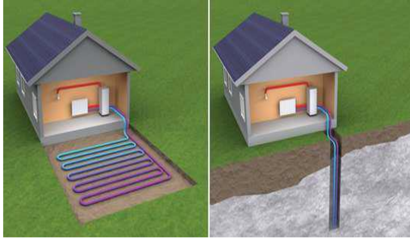
Şekil 2.12. Yatay ve dikey tip toprak kaynaklı ısı pompası gösterimi (Teorik bir villa çalışması)
