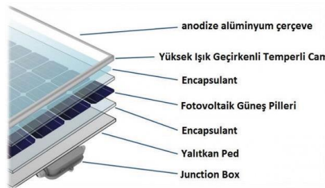
Şekil 2.43. Pv (Fotovoltaik) Ekipmanları
