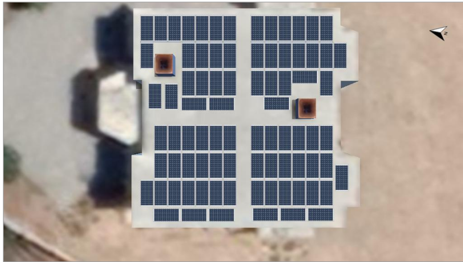
Şekil 4.10. Villa Çatısına Konulan PV (Fotovoltaik) Panellerin Tasarımı
