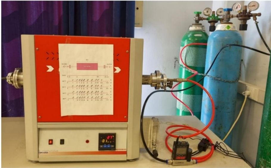
Şekil 3.4. Farklı atmosfer ve gaz akış hızlarında yapılan ısıl tavlama işlemlerinde kullanılan tüp fırın.
