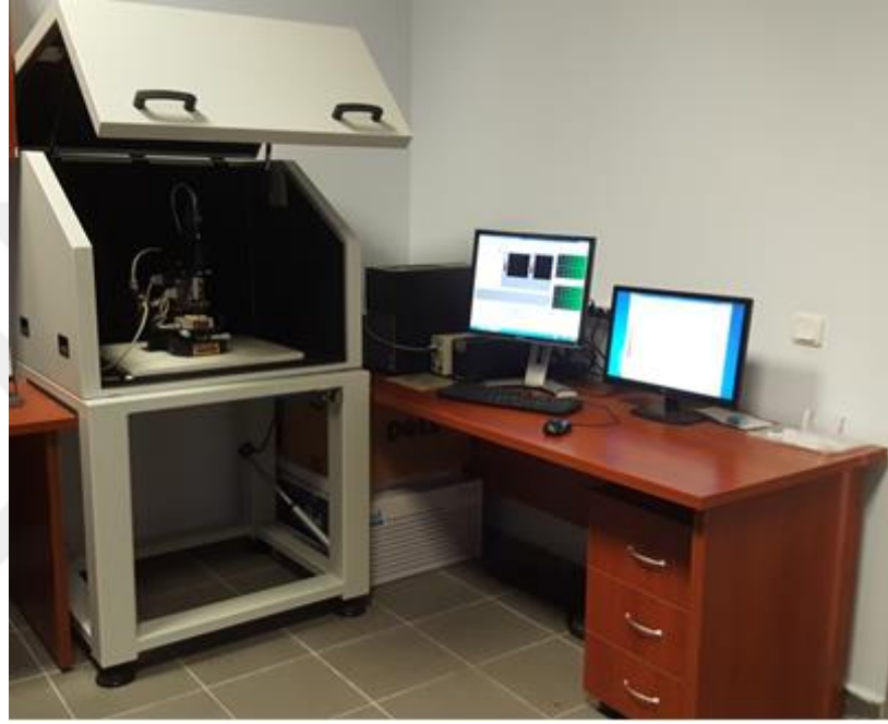
Şekil 3.22. Park Systems XE-100 Atomik Kuvvet Mikroskobu.
