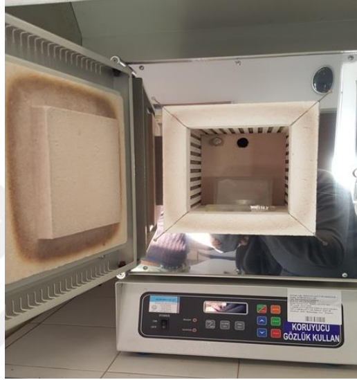
Şekil 3.3. Farklı sıcaklıklarda yapılan ısıl tavlama işlemlerinde kullanılan kamara tip fırın.
