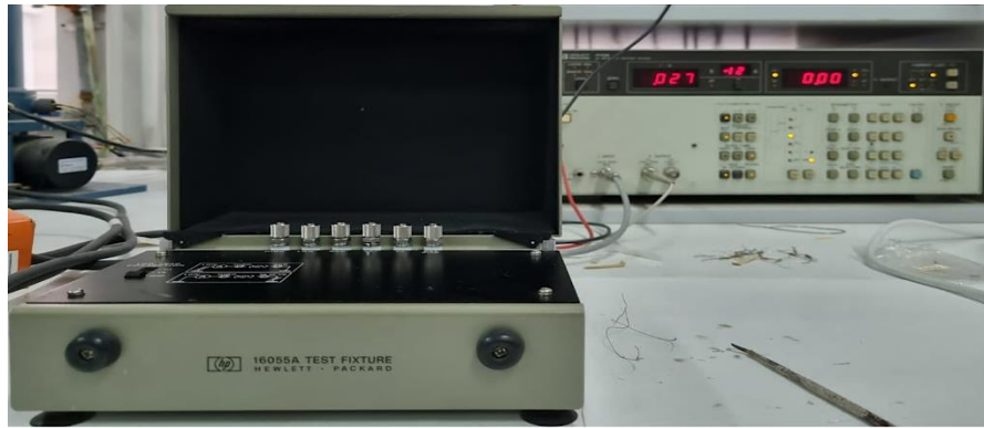
Şekil 3.24. Elektriksel özelliklerin araştırılmasında kullanılan Hewlett Packard 4140B pA meter/DC Voltage Source iki uç sistemi.
