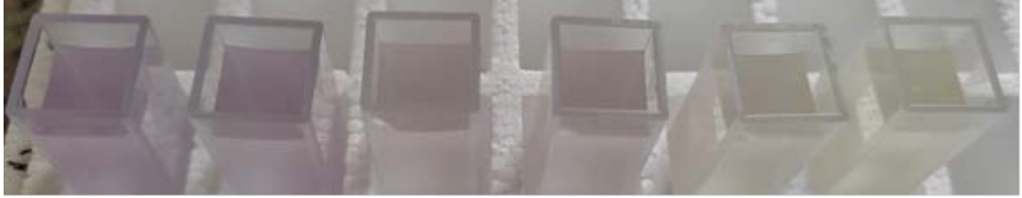
Şekil 3.4. DPPH yönteminde zaman geçtikçe renk kaybına uğramış olan analitik numuneler
