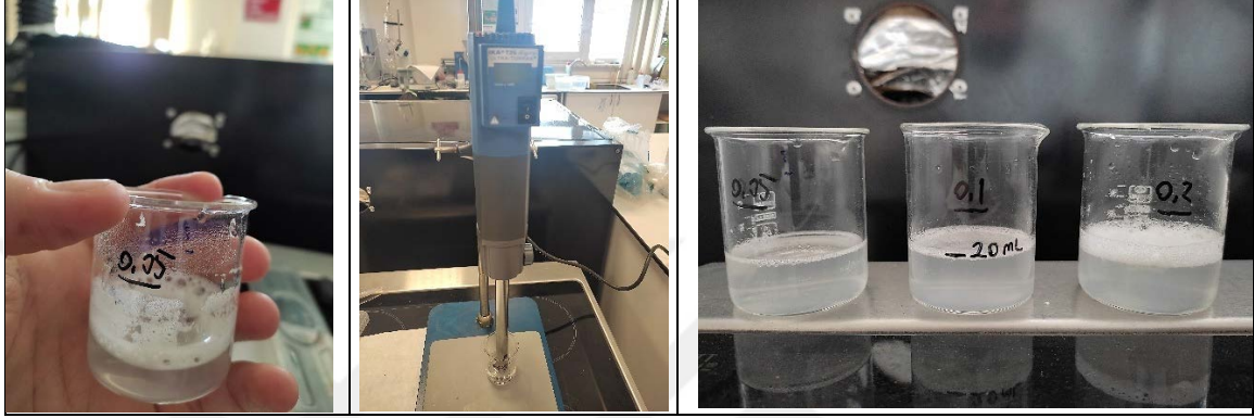
Şekil 3.11. AÇK ve HKP numunelerinin köpük oluşturma özelliğinin tayin edilmesi aşamaları
