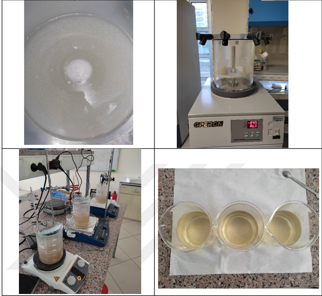
Şekil 3.2. Enzimatik yöntem kullanılarak HKP numunelerinin elde edilmesi aşamaları
