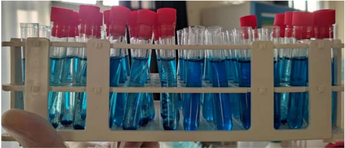
Şekil 3.7. Demir indirgeme yöntemindeki reaksiyon ortamında hidrolizat numunelerinin çökelti oluşturması
