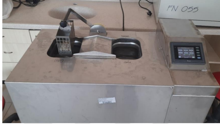
Şekil 3.9. Çalışmada kullanılan termal siklus cihazı
