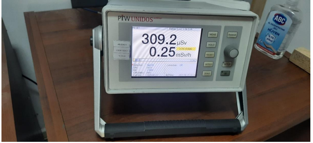
Şekil 3.23. Işınlama süresi sonunda ölçüm yüzeyinde saptanan doz düzeyi
