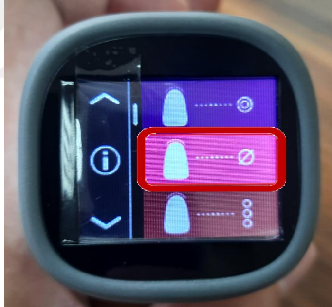
Şekil 3.13 VITA Easyshade V kullanıcı ekranının aritmetik ortalama veren sekmesi
