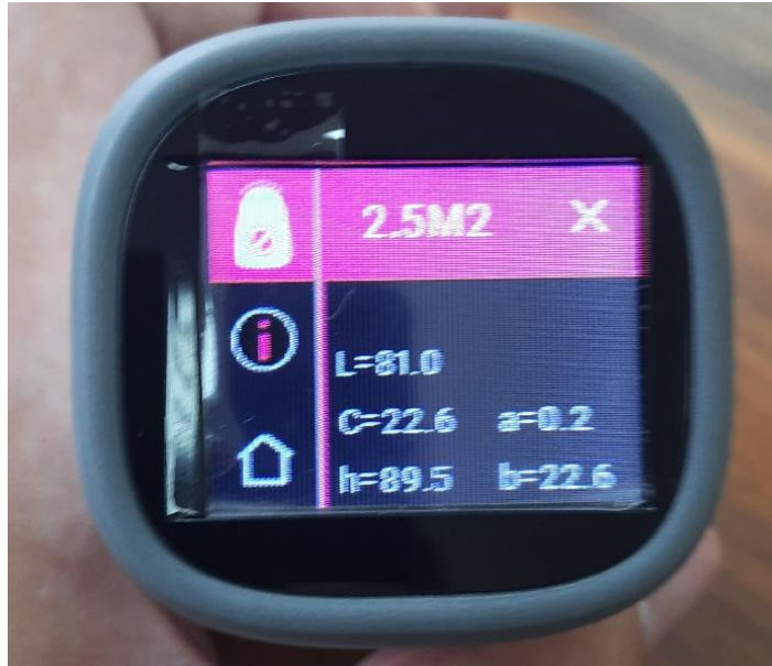
Şekil 3.16. Renk tonu bilgi ekranı (Ölçülen numuneye ait L^* , a^* ve b^* değerlerinin alındığı ekran)
