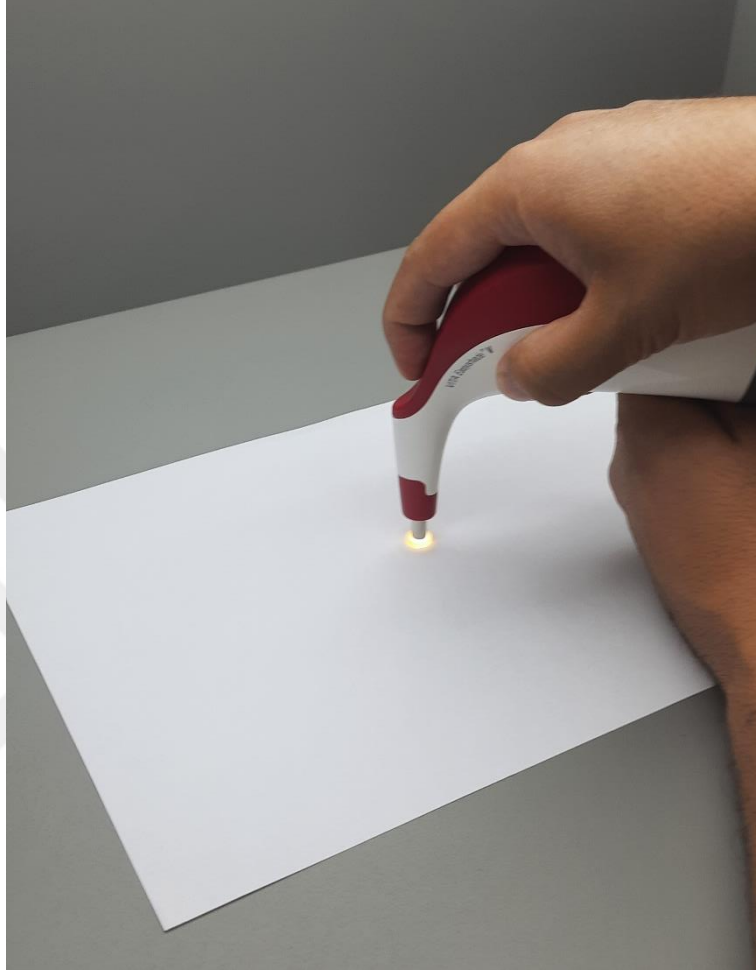
Şekil 3.14. Ölçüm kabinde VITA Easyshade V dijital spektrofotometresi kullanılarak bir numuneye ait renk ölçümünün alınması
