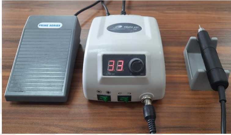
Şekil 3.6. Numunelerin kodlanması için kullanılan mikromotor
