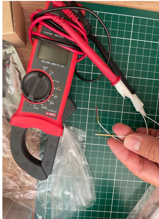
Şekil 4. 16. Ölçüm için kullanılan ölçü aleti ve pinlerin bağlantısı
