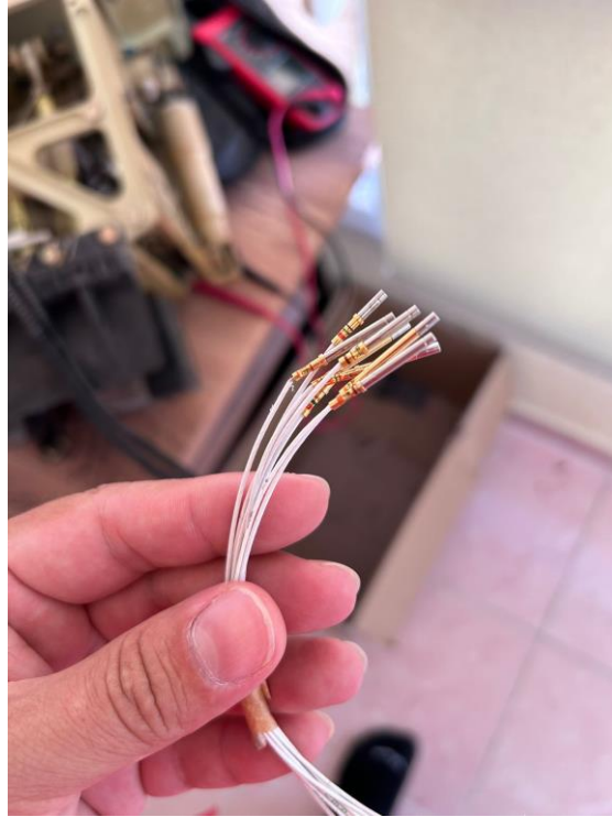
Şekil 4. 15. Ölçüm için hava aracı lisanslı pinler
