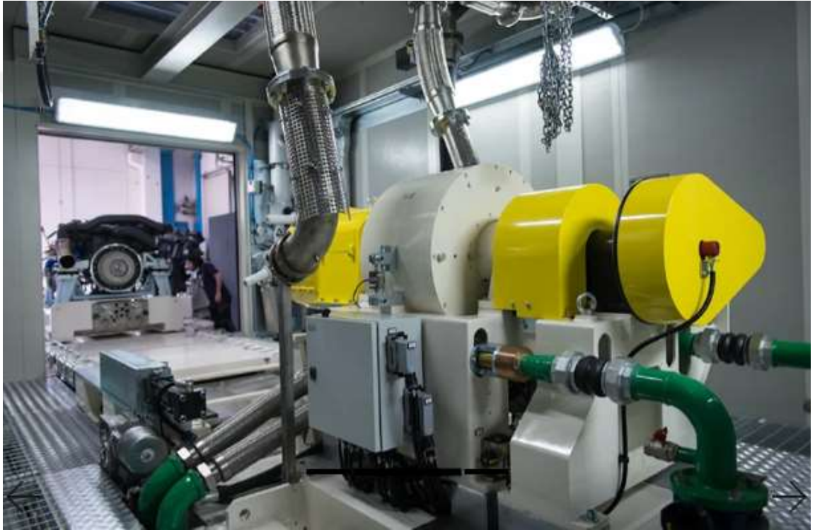
Şekil 3.1: Deneyde kullanılan motor dinamometresi [17].
