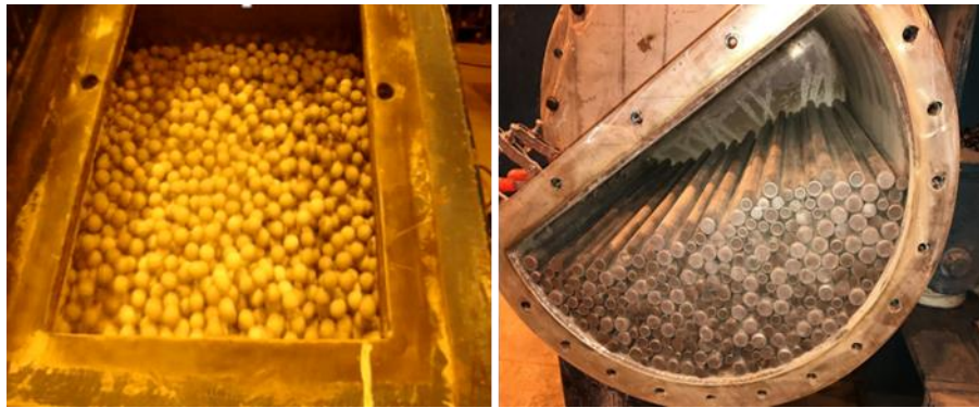
Şekil 1.4 : Bilya (sol) ve çubuk (sağ) öğütücü ortam tipleri.
