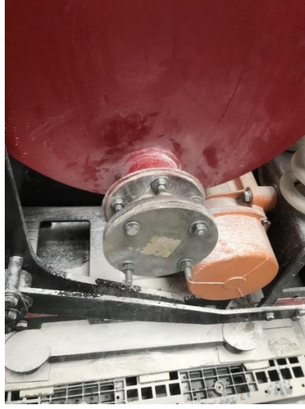
Şekil 2.2 : Laboratuvar ölçekli titreşimli değirmen çıkışı.
