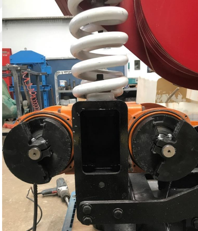
Şekil 1.9 : Laboratuvar ölçekli Vibra-Drum öğütücü titreşim motoru detayı.
