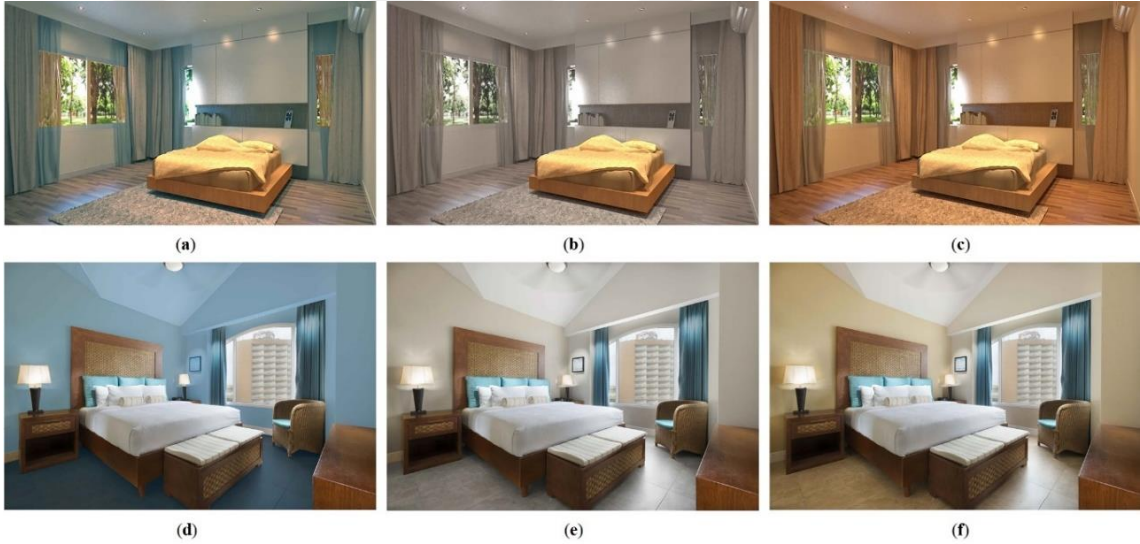
Şekil 4. 26: İlk deneyde, ışık renk sıcaklıkları ve renk tonları incelenmiştir. Işık renk sıcaklıkları; (a) serin (6.500 K), (b) beyaz (4.000 K), (c) sıcak (2,800 K).
