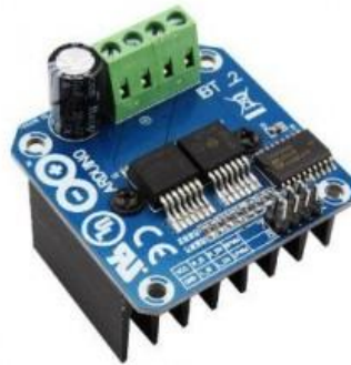
Şekil 3.20. BTS7960 Modüle Genel Bakış.
