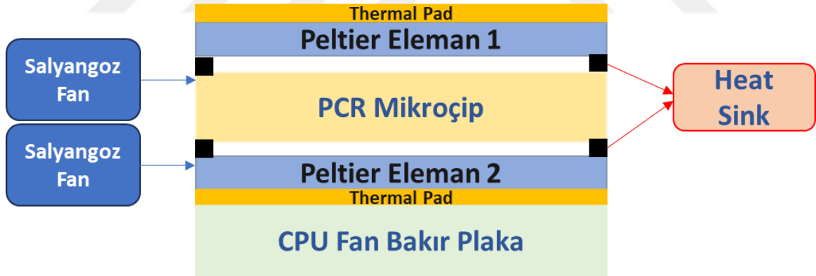
Şekil 6.14. PCR kutusunun blok diyagramı.
