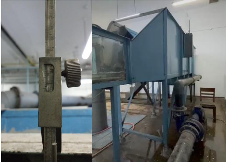
Şekil 3.5 : Savak yükü ölçümü için milimetre.
