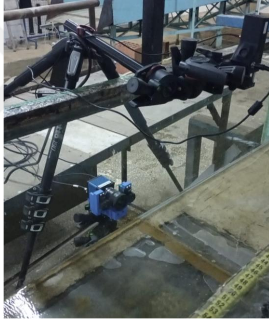
Şekil 3.2 : Parçacık görüntülü hız ölçümü (PIV).
