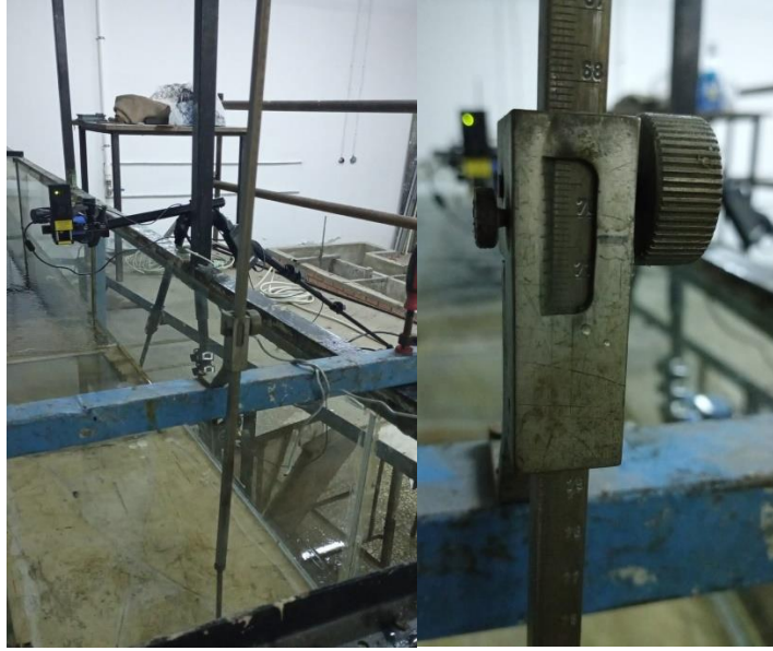
Şekil 3.4 : Su seviyesi ölçümü için milimetre.
