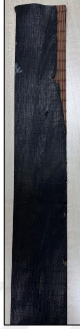
Şekil 6.9. Kaplanmamış alan olan hatalı malzeme örneği
