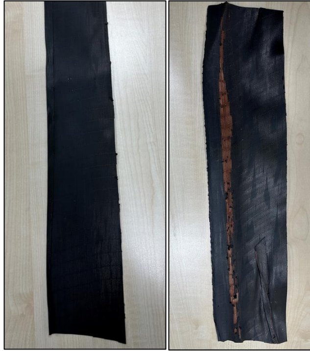
Şekil 6.6. Kaplanmış normal(solda) ve kaplanmamış (sağda) malzeme örneği
