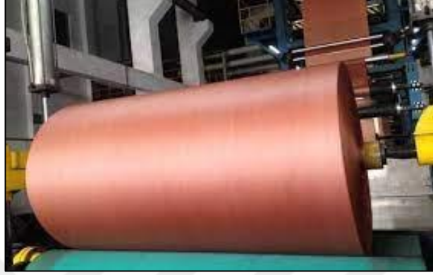
Şekil 6.4. Kauçuk kaplanmamış Kord (ip)’lu bobin örneği [149] .
