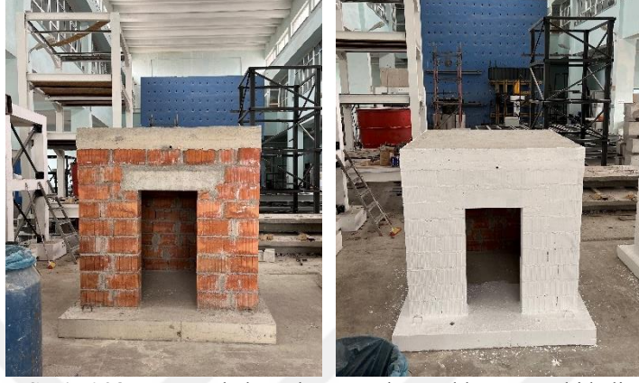
Şekil 6.28. Yapının kalıp sökümü ve boyandıktan sonraki hali
