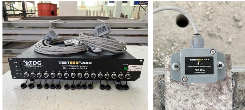
Şekil 6.35. TDG Testbox 2010 veri toplama ünitesi ve TDG Sensebox7013 ivmeölçerleri
