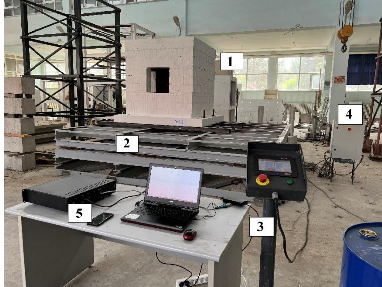
Şekil 6.37. Deney düzeneği; 1) Yığma yapı numunesi, 2) Sarsma tablası, 3) Kontrol paneli, 4) PLC sistemi, 5) TDG Testbox 2010 veri toplama ünitesi.
