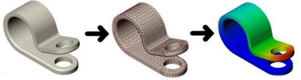
Şekil 45: Geometrik model, sonlu eleman modeli ve sonuçların gösterildiği nodal sonuçlar (Çayıroğlu, 2024)
