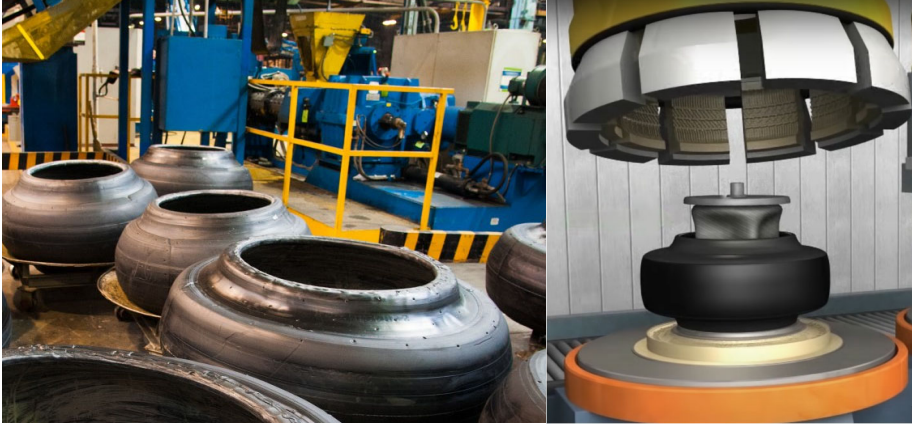
Şekil 24 a: Kürleme Öncesi Lastik Numunesi b: Kürleme Kalıbı ve Kürleme Lastiği Görünümü (“How Tire Made” Ustires, 2024)
