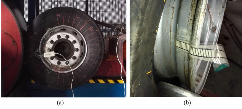
Şekil 4: Ticari bir araç tekerleğinin lastik-jant arayüzü basınç testi: (a) Test Yapısı ; (b) Şerit Film Basınç Sensörü.
