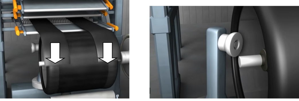
Şekil 20: a) Yan Duvarların Yerleşimi b) Fazlalık Kısımların Bir Teker Yardımı İle İçe Bükülmesi (“How Tire Made” Ustires, 2024)
