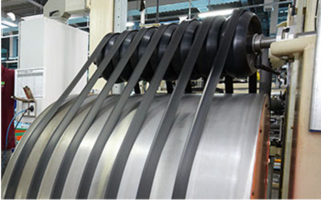
Şekil 15 Topuk Teli ve Kaplanması Prosesi (“Product Process” Nexentire, 2024)
