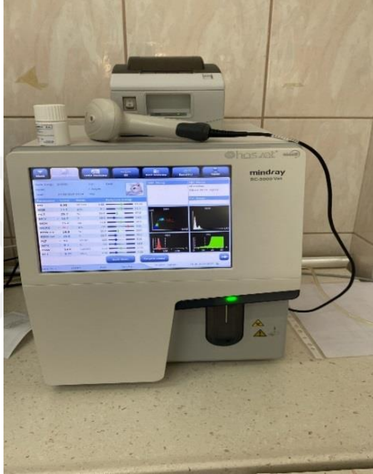
Şekil 2. Hematolojik analiz cihazı
