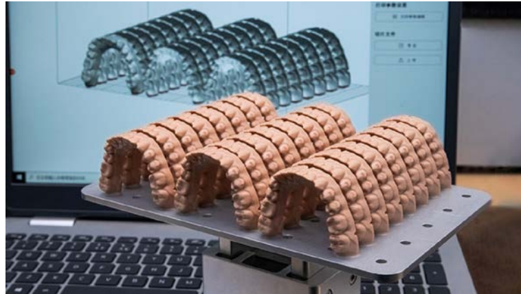
Şekil 2.17. SLA Dental 3B Yazıcı Çıktıları
