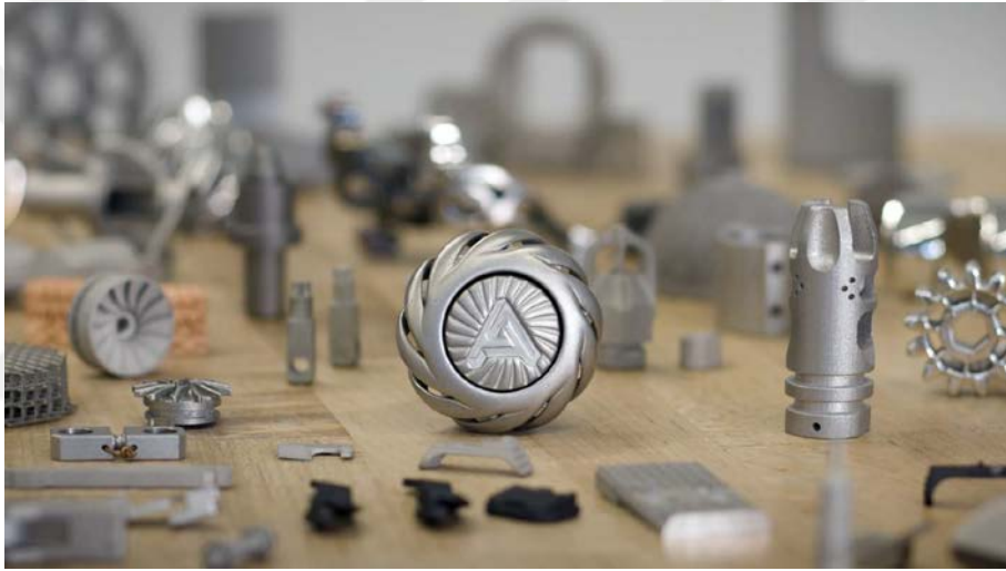
Şekil 2.4. Binder Jetting Teknolojisi Çıktıları
