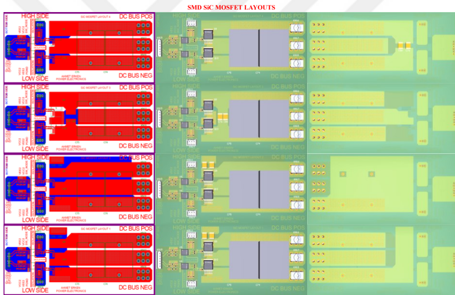
Şekil A.4 SMD SiC MOSFET baskı devre yapıları
