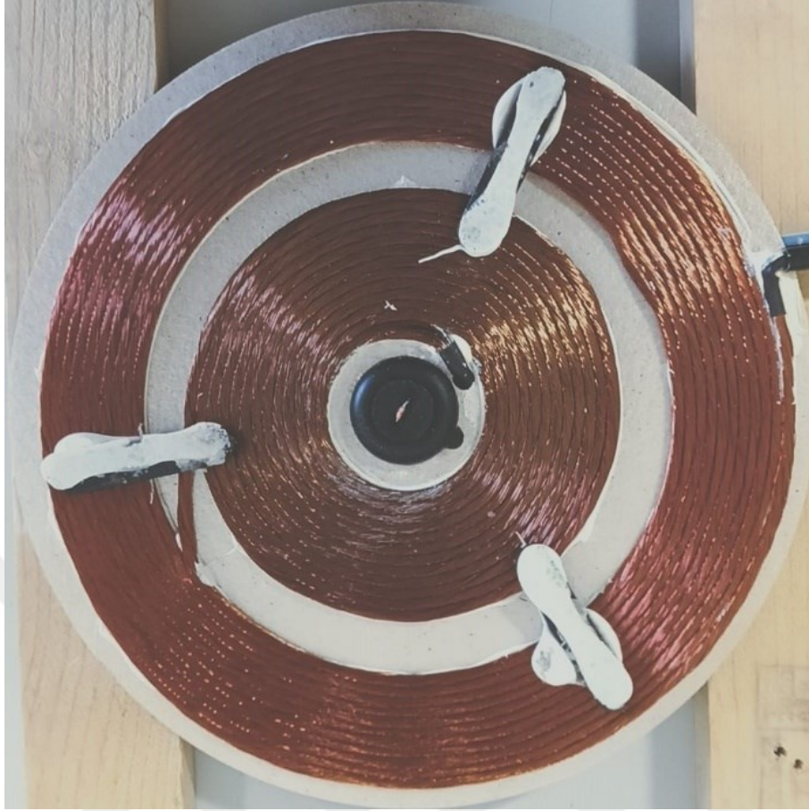
Şekil 2.6 Ev tipi indüksiyon ocaklarda kullanılan indüksiyon bobininin yapısı
