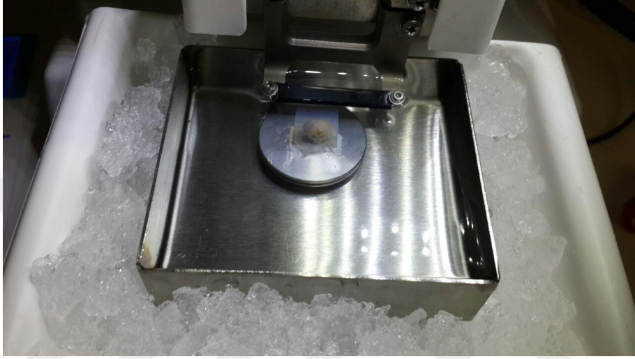
Şekil 3.6. Agarozla gömülü beyin dokusundan vibratom kullanılarak kesit alınması.
