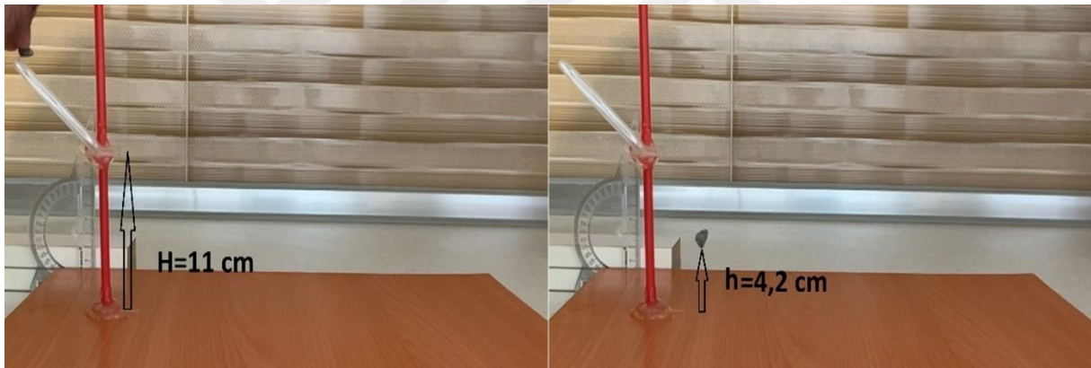
Şekil 32. 6,30 ile 8,00 mm arası köşeli dane ile ahşap duvar arası restitüsyon katsayısını hesaplama deney aşamaları
