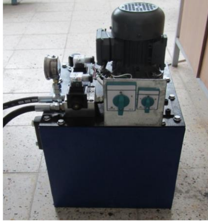
Şekil 16. Hidrolik pompa kontrol ünitesi
