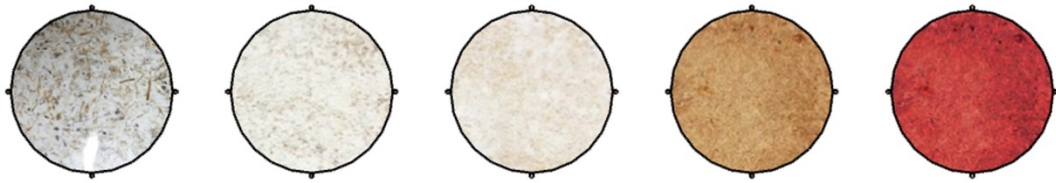
Şekil 36. Tasarlanan sürdürülebilir sehpa tablalarının orjinal malzeme atanarak model üzerinde çalışılması (sırasıyla fırınlanmamış miselyum, preslenmemiş miselyum, soğuk preslenmiş miselyum, sıcak sıcak preslenmiş miselyum, renklendirilmiş gıda boyası ile büyüme aşamasında renklendirilmiş miselyum)
