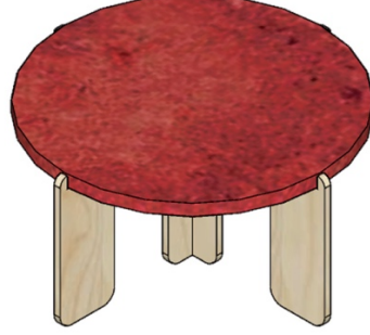
Şekil 39. Tasarlanan sürdürülebilir sehpa tasarımının sıcak preslenmiş ve kırmızı gıda boyası ile renklendirilmiş miselyum tablası ve kontrplak ayaklardan oluşan malzeme atamasıyla 3D görünümü
