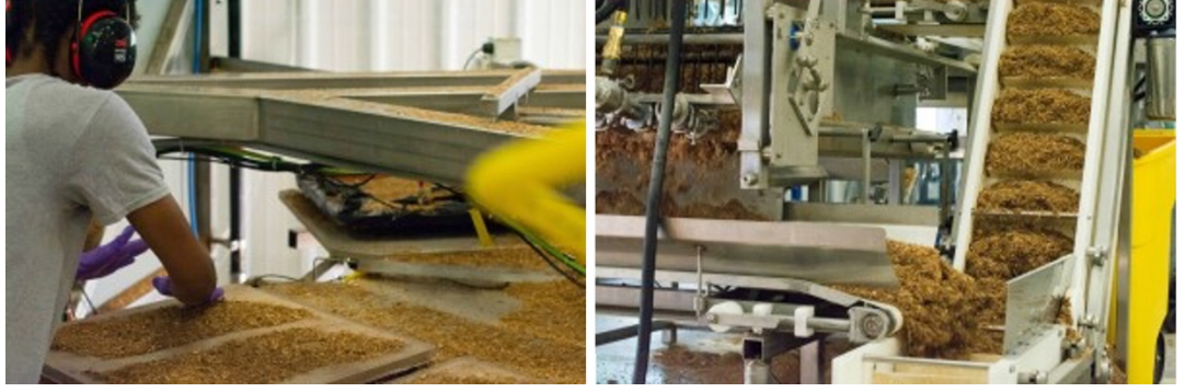
Şekil 19. Ecovative Design Miselyum kompozitlerinin ticari ürün olarak üretilme aşamaları (URL 29)
