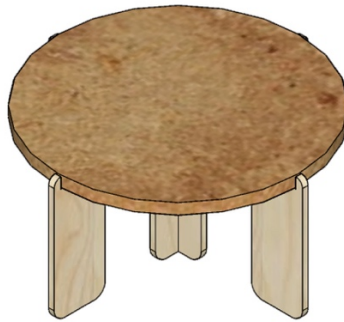
Şekil 38. Tasarlanan sürdürülebilir sehpa tasarımının sıcak preslenmiş miselyum tablası ve kontrplak ayaklardan oluşan malzeme atamasıyla 3D görünümü
