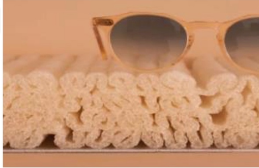
Şekil 9. Mısır nişastası köpüğünden elde edilen biyomalzeme raf üretimi (Yılmaz, 2023)
