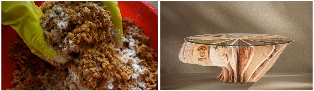
Şekil 21. Miselyumun substrat olarak hazırlanma süreci ve 3D üretimle tasarlanan sehpa tasarımı (URL 31)
