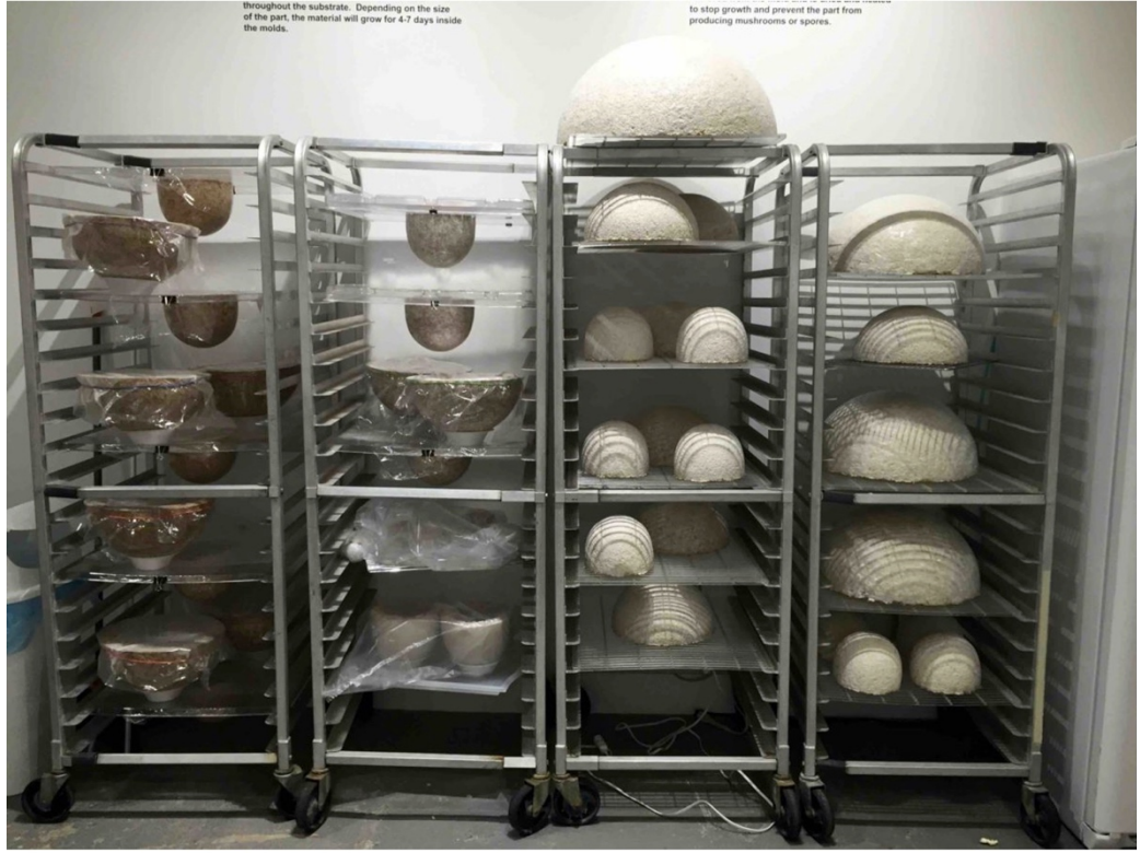
Şekil 14. Danielle Trofe tarafından tasarlanan ve ticari ürüne dönüştürülen miselyum bazlı aydınlatma elemanları tasarımları üretim aşaması (URL 24)
