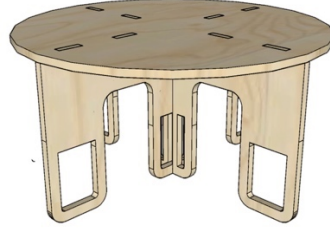
Şekil 30. Tasarlanan sürdürülebilir sehpa tasarımının mekanik dayanımının artırılmış halinin kontrplak malzeme atamasıyla 3D görünümü
