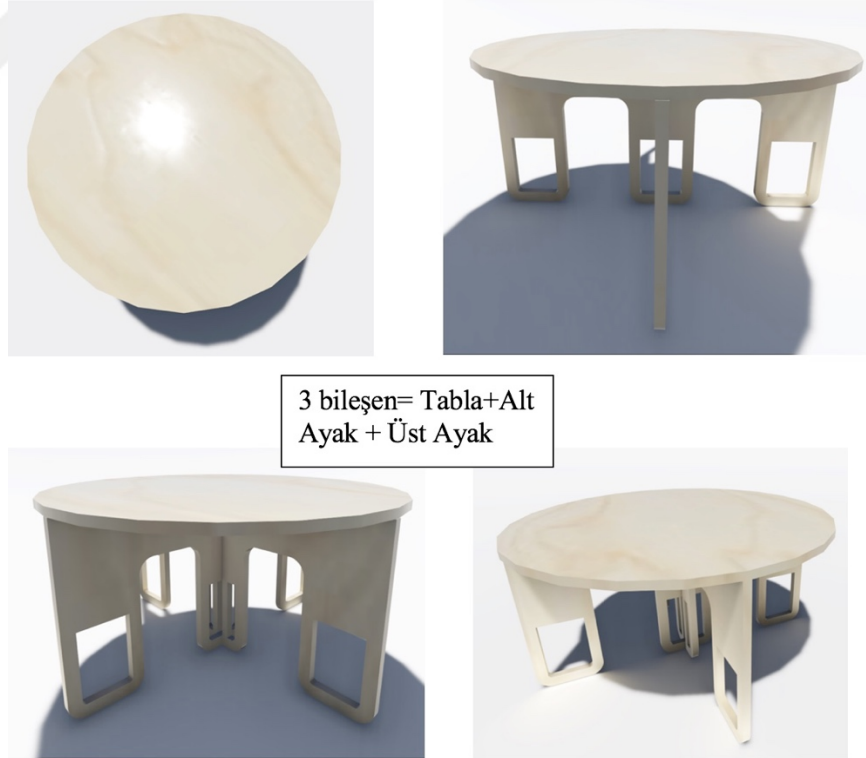
Şekil 32. Tasarlanan sürdürülebilir sehpa tasarımının güçlendirilmiş halinin kontrplak malzeme ile render görünümü
