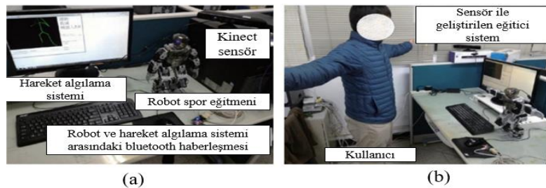
Şekil 2.1. Spor eğitmeni sistemi: (a) sistemin kurulumu, (b) hareket tanıma (Ding ve Chang, 2016)
