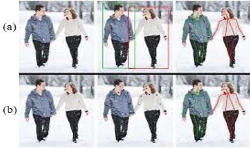
Şekil 3.4. Poz tahmin yöntemleri: (a) yukarıdan aşağıya, (b) aşağıdan yukarıya (Liu vd., 2021)
