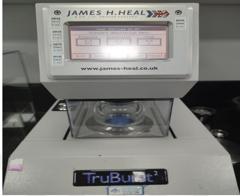
Şekil 13. MEM Tekstil Fizik Laboratuvarındaki Patlama mukavemeti test cihazı görüntüsü
