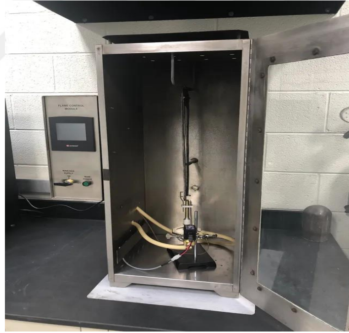
Şekil 15. Gaziantep Üniversitesi Mühendislik Fakültesi Tekstil Mühendisliği Bölümü Laboratuvarındaki Dikey Yanmazlık test cihazı görüntüsü
