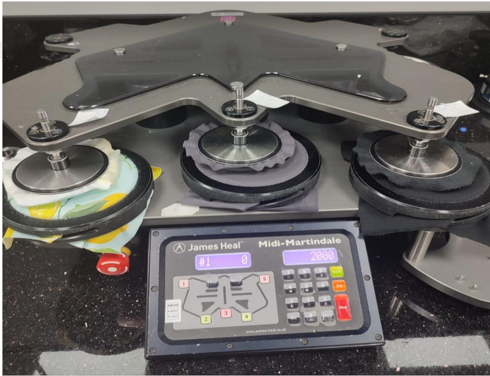
Şekil 12. MEM Tekstil Fizik Laboratuvarındaki Martindale test cihazı görüntüsü
