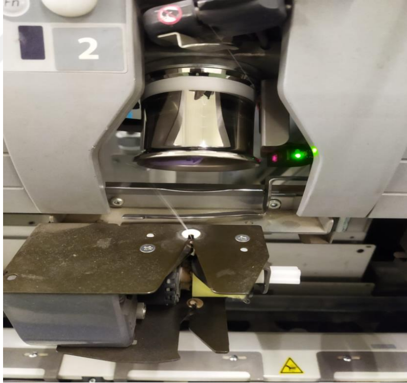
Şekil 5. Muratta Vortex iplik üretim makinesi iğ sistemi
