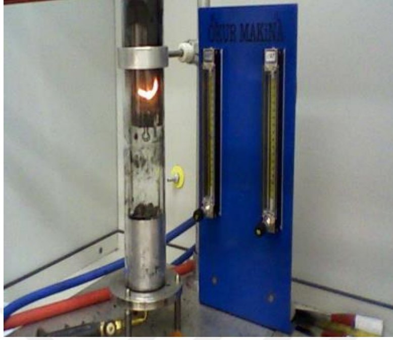
Şekil 14. Dokuz Eylül Üniversitesi Mühendislik Fakültesi Tekstil Mühendisliği Bölümü Laboratuvarındaki LOI test cihazı görüntüsü
