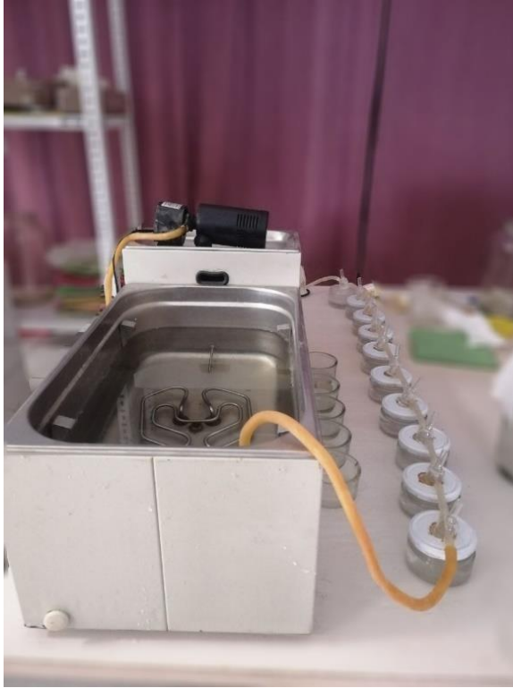
Şekil 3.5: Benmari, devirdaim motoru ve sıralanması; deve boynu camlar.
