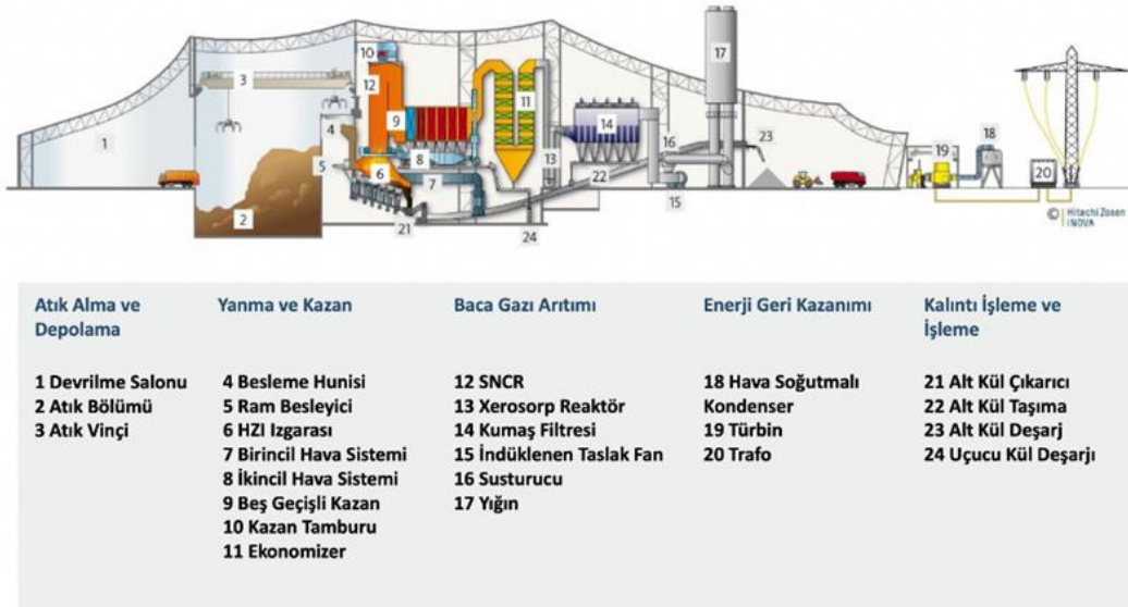
Şekil 2.4 Kentsel katı atık yakma tesisi üniteleri [42]
