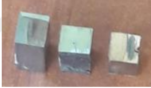
Şekil 6.19. Soldan sağa doğru GG25, Ni 3 Al ve bronz test numuneleri
