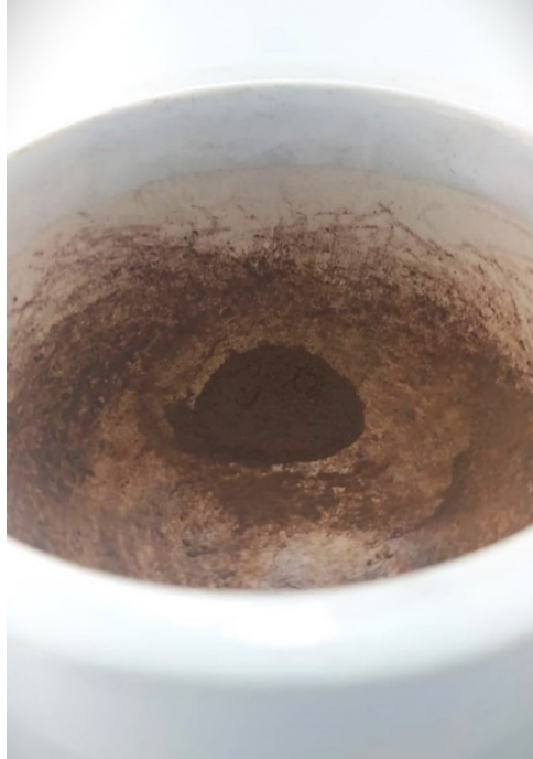
Şekil 3.8. Havanda mekanik etkiyle ince toz haline getirilen C-CS@AgNP
